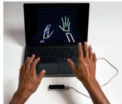
Şekil 3. LM'nin El ve Parmakları Tarama Şekli (Leap Motion, 2020)
