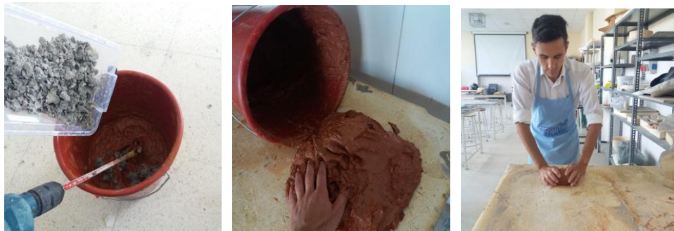
Resim 118. Kağıt Katkılı Kırmızı Çamurun Hazırlanma Aşamaları (Karademir, 2018)
