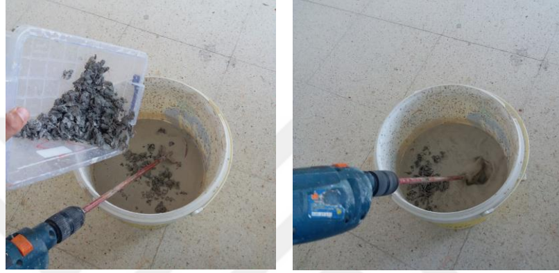
Resim 99. Döküm Çamurunun Gazete Kağıtları ile Karıştırılması (Karademir, 2018)
