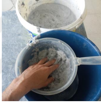
Resim 98. Lapa Haline Getirilen Kağıtların Elekten Geçirilmesi (Karademir, 2018)
