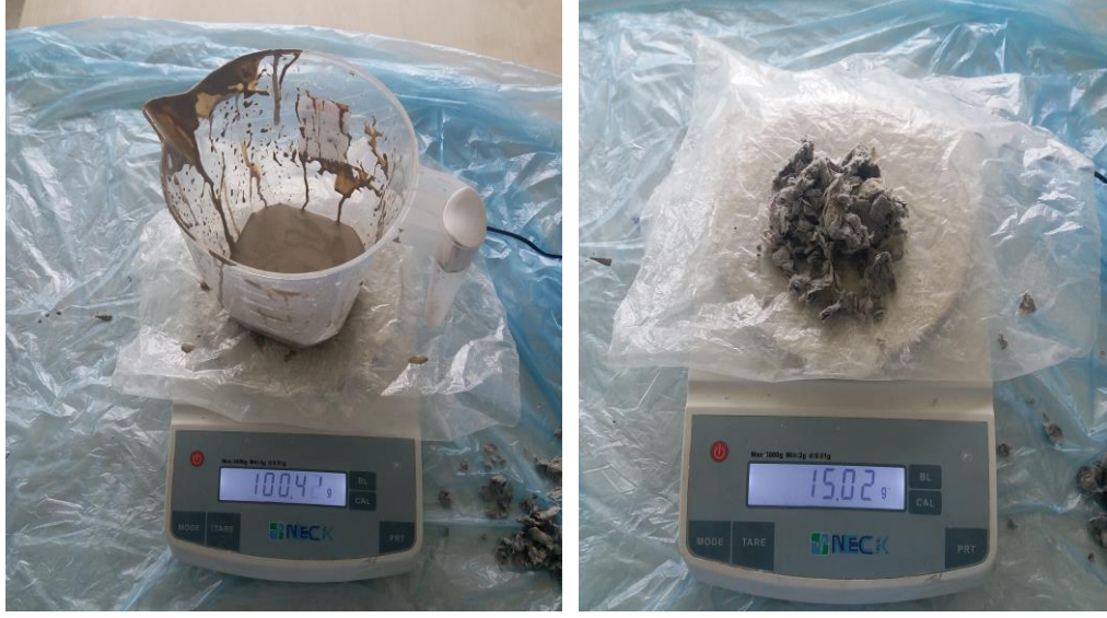
Resim 102. Akçini Çamuruna Karıştırılan Gazete Kağıdının Oranlarının Gösterilmesi(Karademir, 2018)
