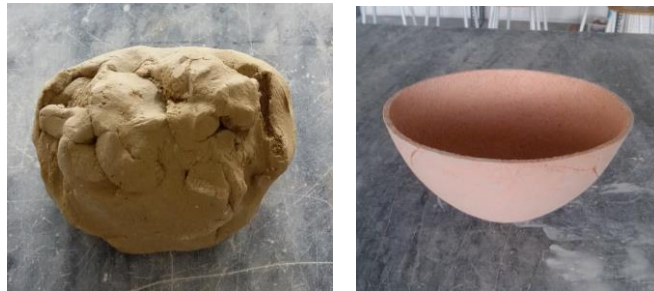
Resim 20. Şamot Çamurunun Yaş ve İlk Pişirimi Yapılmış Şekli 1000 °C (Karademir, 2017)
