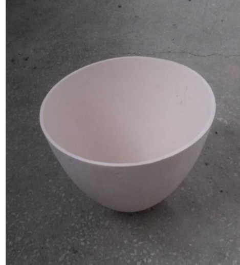
Resim 18. Döküm Çamurunun Yaş ve İlk Pişirimi Yapılmış Şekli 1000 °C (Karademir, 2017)
