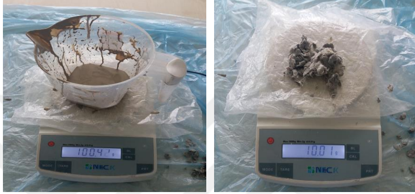
Resim 131. Porselen Çamuruna Karıştırılan Gazete Kağıdının Oranlarının Gösterilmesi (Karademir, 2018)
