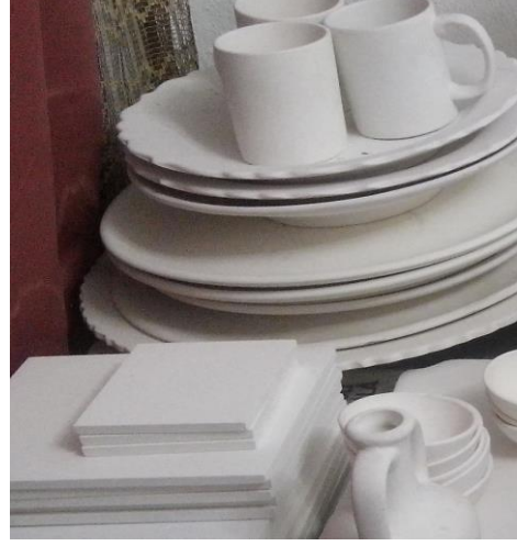
Resim 17. Akçini Çamurunun Yaş ve İlk Pişirimi Yapılmış Şekilleri 960 °C (Karademir, 2017)
