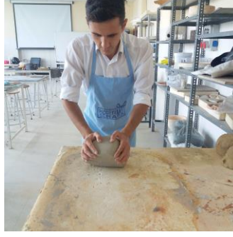
Resim 101. Döküm Çamurunun Alçı Masada Yoğrulması (Karademir, 2018)
