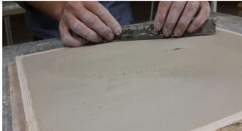
Resim 63. Plastik Kıvamdaki Döküm Çamurunun Plaka Basımı (Karademir, 2017)
