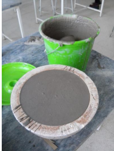
Resim 18. Döküm Çamurunun Yaş ve İlk Pişirimi Yapılmış Şekli 1000 °C (Karademir, 2017)
