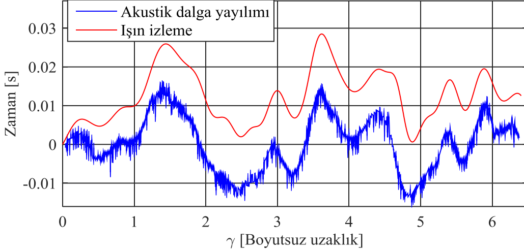
Şekil 4.12: Akustik dalga yayılımı ve ışın izleme yöntemi ile elde edilmiş seyahat zamanı salınımları.
