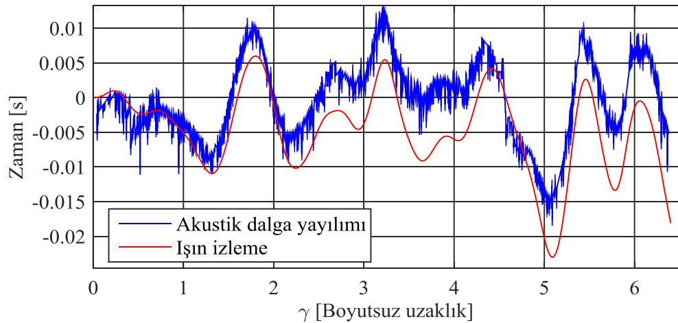
Şekil 4.11 : Akustik dalga yayılımı ve ışın izleme yöntemi ile elde edilmiş seyahat zamanı salınımları.
