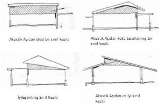
Şekil 3.6. From Architectural Forum, 1949, Sınıfların akustik kalitesinin nasıl artırılabilceğine dair örnek (Baker, 2012, s.15)
