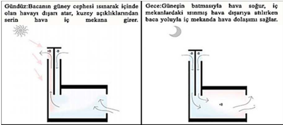
Şekil 4.19. Rüzgar Bacası Çalışma Prensibi (Ali ve Özer, 2012:33)
