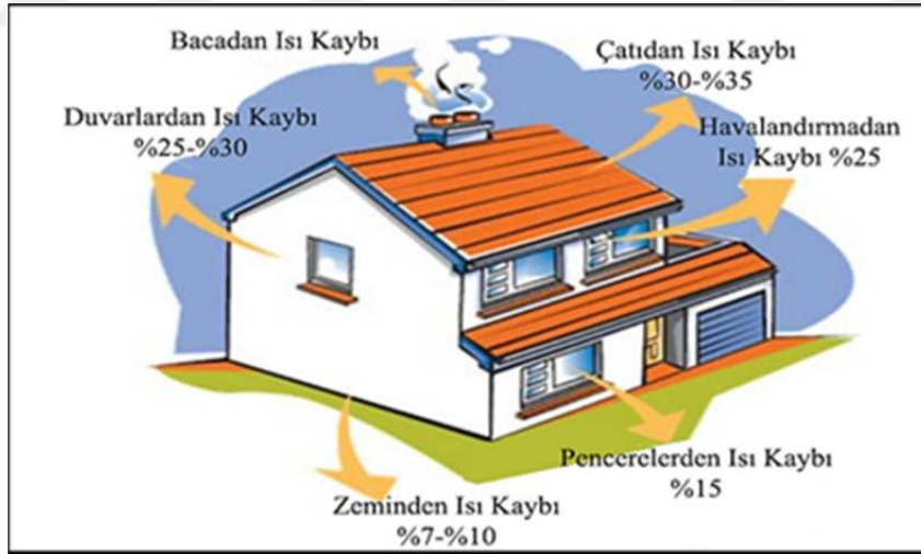
Şekil 4.7. Yapı Bölümlerine Göre Isı Transfer Oranları (Salih, 2015:25)
