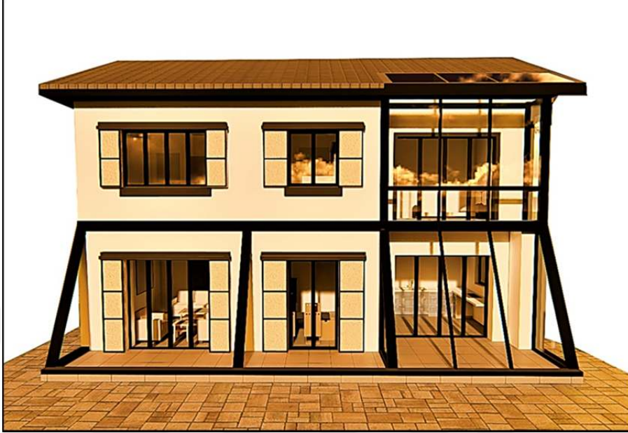
Şekil 5.18. Pencere Panellerinin Açık Şekilde Konumlandırılması
