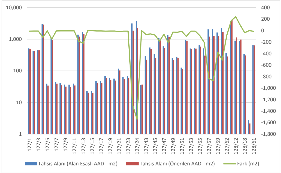
Şekil 38. Alan esaslı AAD ve önerilen AAD yöntemlerine göre elde edilen kesin tahsis alanları arasındaki fark (rezerv alan hariç)
