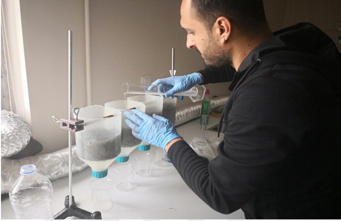
Şekil 2.5. Çalışmada kullanılan toprak-süzüntü düzeneği
