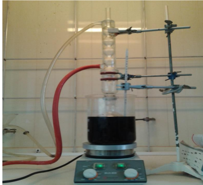
Şekil 4.2. Reflux yöntemiyle S katkılanmış TiO_2 ' in sentez şeması ve reflux sistem
