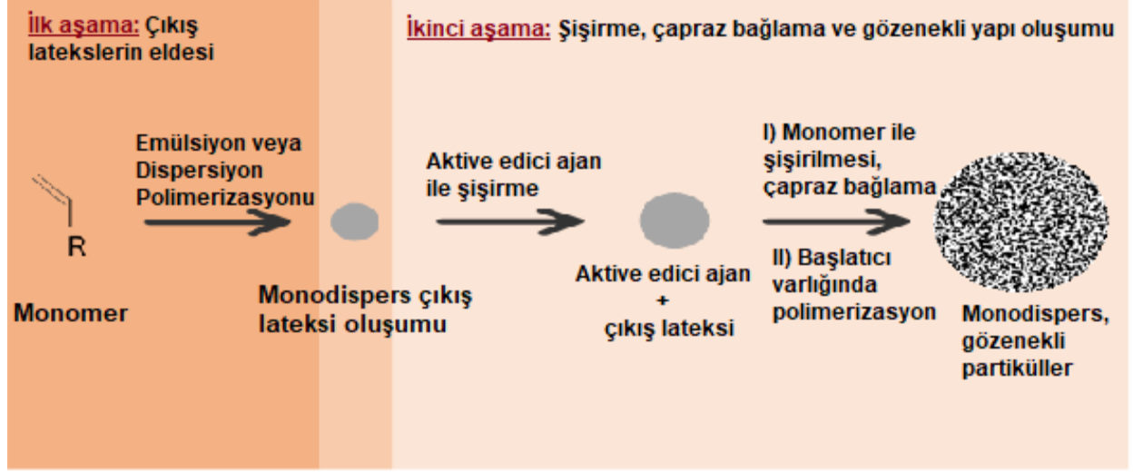
Şekil 2.5. Çok Basamaklı Mikrosüspansiyon Polimerizasyonu [62]
