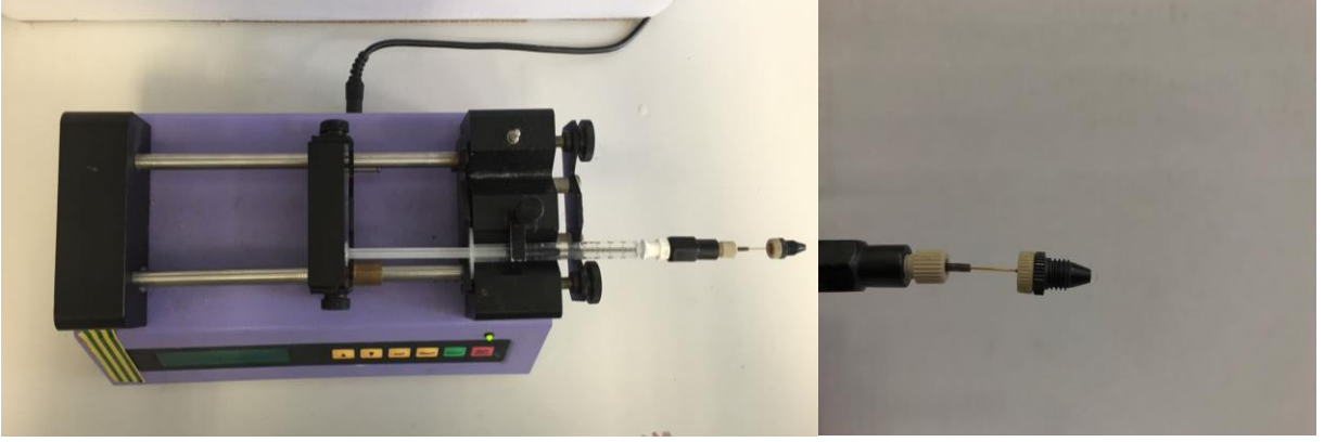
Şekil 3.5. İnsan tam kan örneğinden Hb izolasyonu yapılan sürekli mikroakış sistemi
