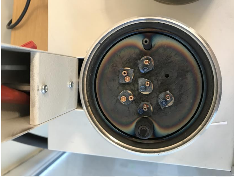
Şekil 3-12: SEM cihazında görüntülenen örnekler
