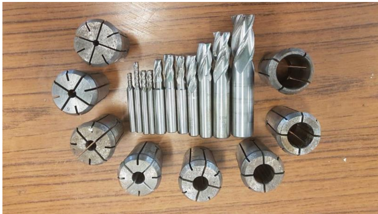
Şekil 3-2: Alüminyum bloklardan alüminyum aparatlar üretmek için kullanılan parmak freze çakıları ve pensler
