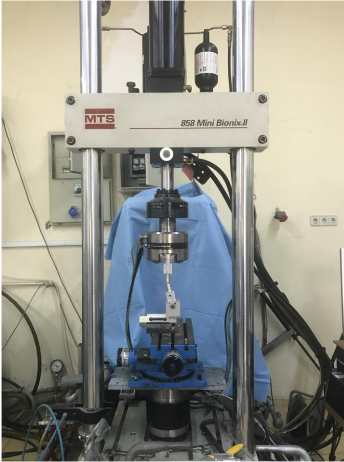
Şekil 3-5: MTS 858 Mini Bionix II, Eden, Prairie, MN ,USA test sistemi
