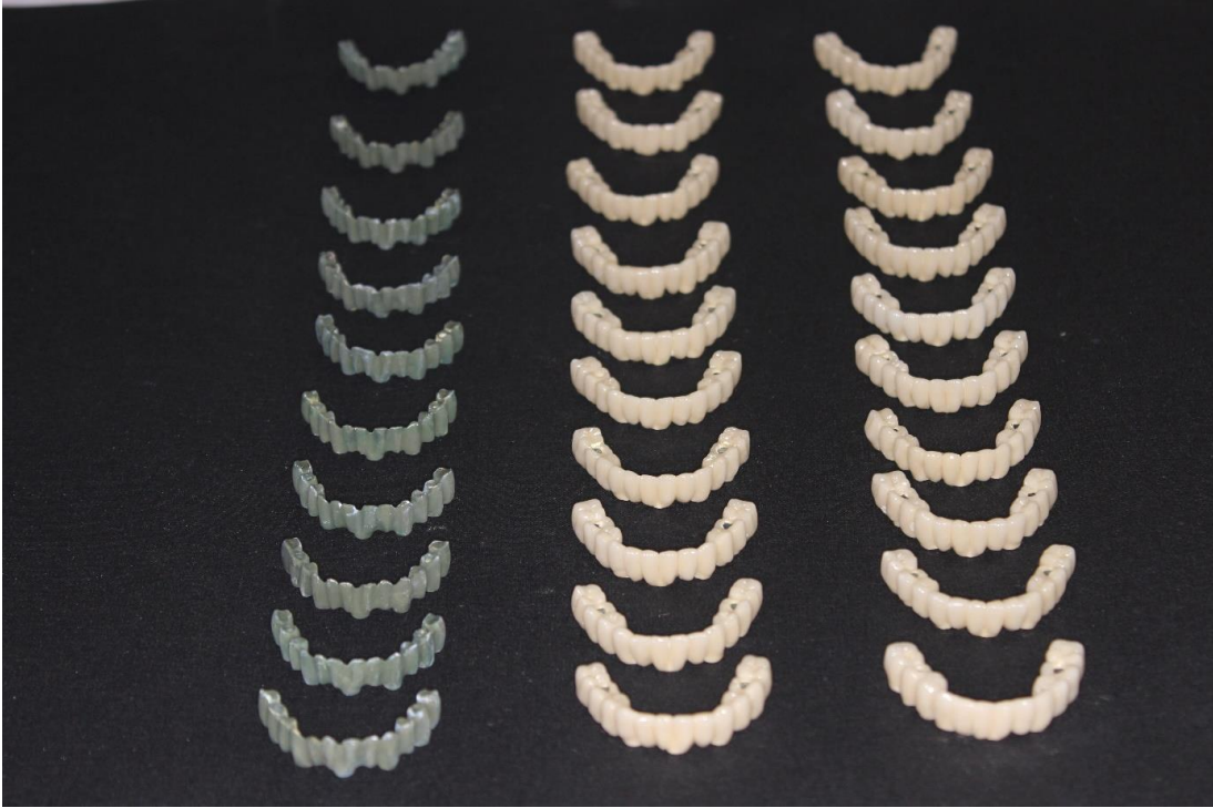
Şekil 3.21: Porselen Uygulanmış CAD/CAM ve Döküm Tekniği ile Üretilen Protezler ile Sadece Isıl İşlem Uygulanan Döküm Metal Altyapılar.
