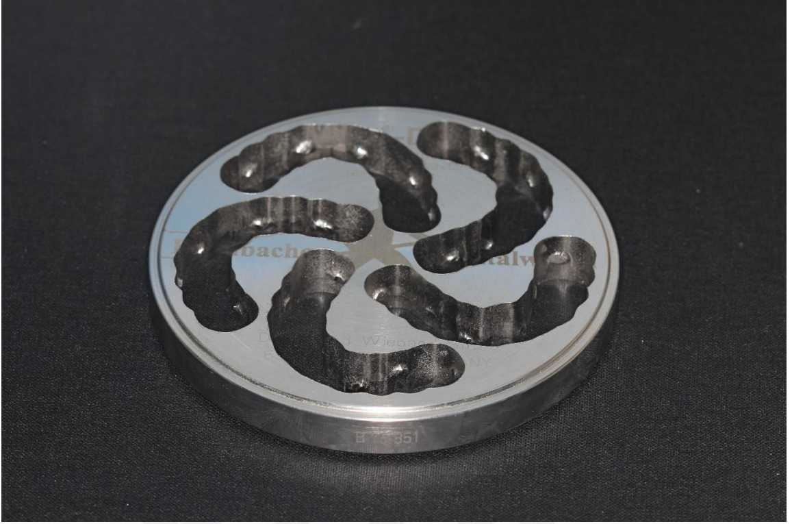
Şekil 3.11: Freze Edilmiş CoCr İçerikli CAD/CAM Blok.
