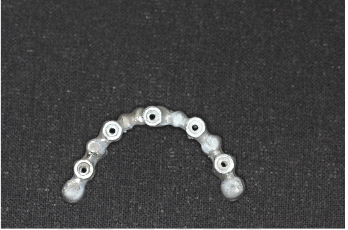
Şekil 3.19: Kumlanmış ve Döküm Yolları Kesilmiş Döküm Altyapı.
