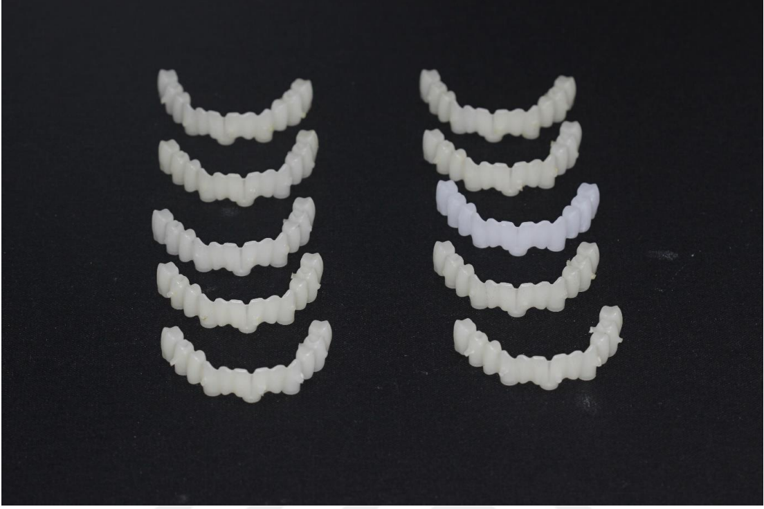
Şekil 3.15: PMMA Bloktan Elde Edilen On Adet Altyapı Modelajı.
