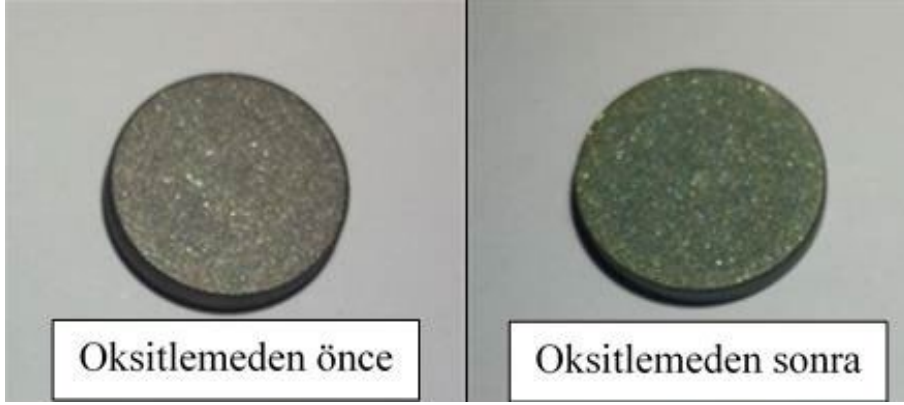
Şekil 24. Ti-6Al-4V örneklerinin oksitleme işleminden önceki ve sonraki fotoğrafları
