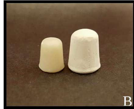
Fotoğraf 3.17. A. Sinterizasyon fırını B. Sinterizasyon öncesi ve sonrası zirkonya alt yapı
