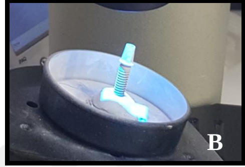
Fotoğraf 3.5. A. Optik okuyucuya bağlanmış dayanak B. Optik ölçü alımı
