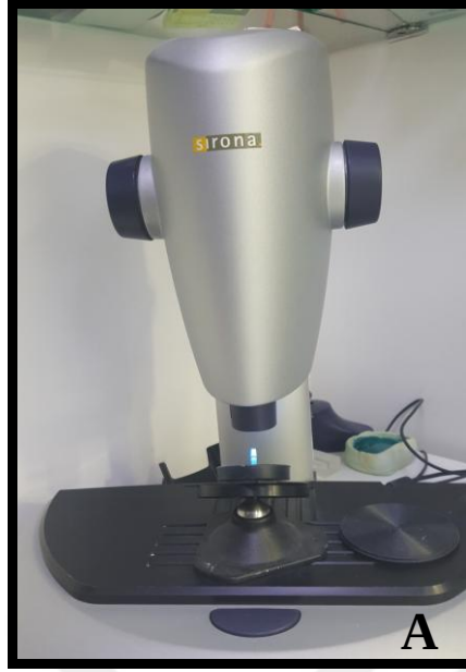
Fotoğraf 3.5. A. Optik okuyucuya bağlanmış dayanak B. Optik ölçü alımı
