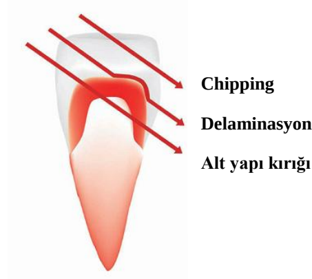
Şekil 2.5. Tam seramik kronlarda başarısızlık tipleri. Kwon ve ark. (161)’ndan alınmıştır.
