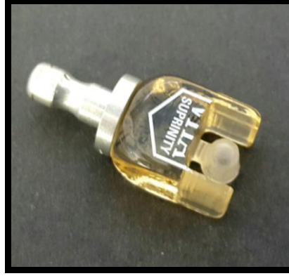
Fotoğraf 3.9. Kazıması tamamlanan alt yapı
