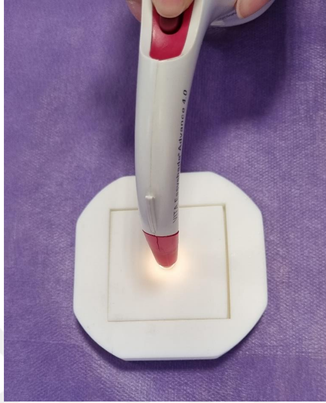
Şekil 3.17 Fotopolimer Rezin Kalıbın Konumlandırıcı Parçasının Yerleştirilip Renk Ölçümünün Gerçekleştirilmesi
