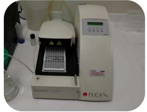
Şekil 4. İnkubasyon sonrasında ELISA yıkama cihazı ile yıkanması
