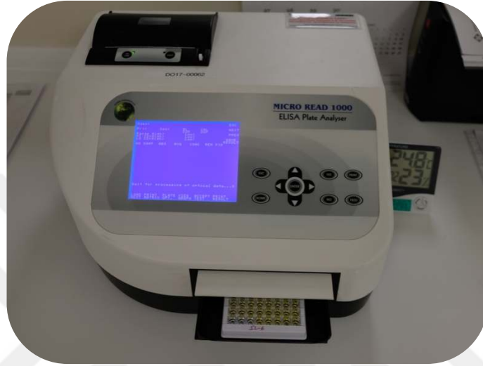
Şekil 5. ELISA plağının GENTAU MICRO READ 1000 cihazı ile 450 nm’de okunması
