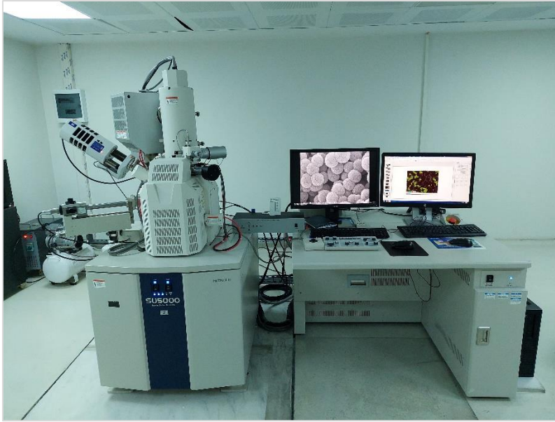
Resim 3.21. Mikroskopik inceleme için kullanılan taramalı elektron mikroskobu (SEM) ve ışık kamerasının görüntüsü
