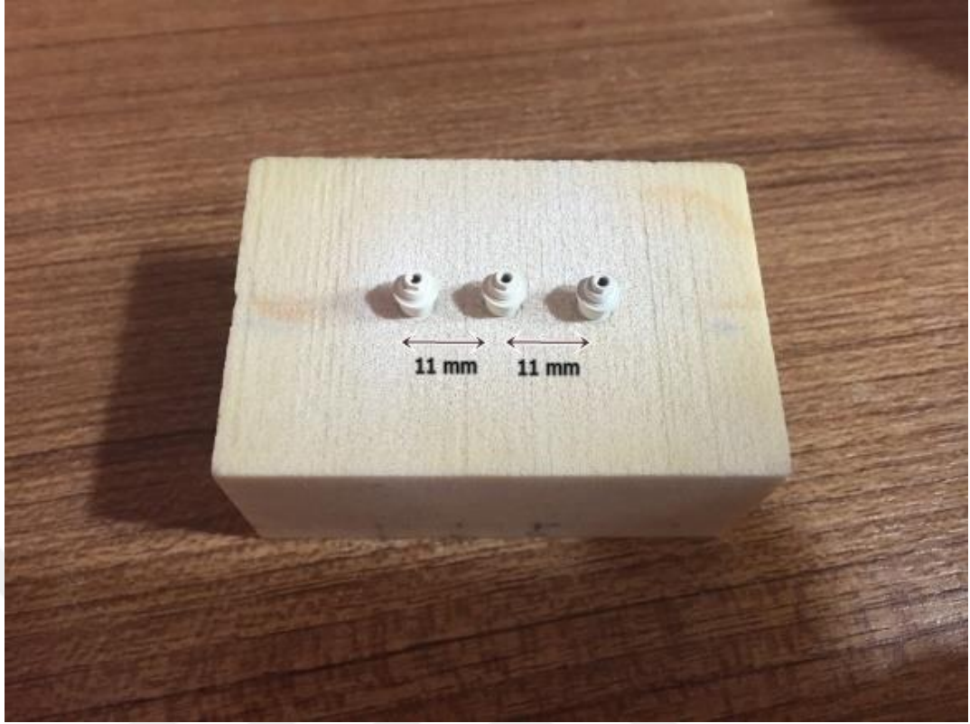
Şekil 3-10: Çizgisel yerleştirilmiş implantlar ve oklüzal vidalı abutmentların (3D) tarama işlemi öncesi görünümü.
