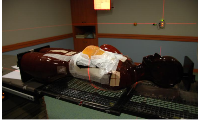
Şekil 2.25 Transvers kesitli meme şeklinde fantomla rando fantomun set-up'ı
