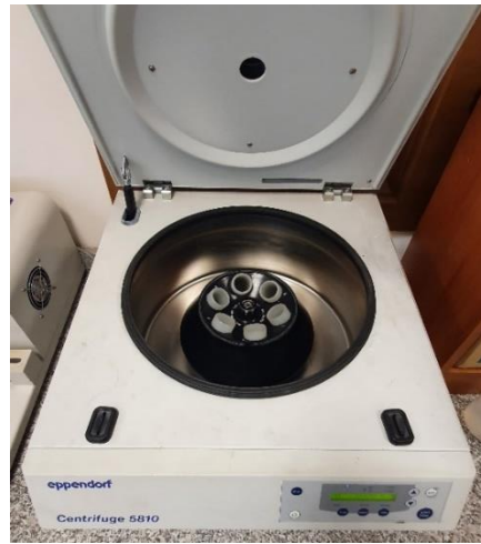
Şekil 3.11. Partikülleri asit çözeltisinden ayırmada kullanılan santrifüj cihazı
