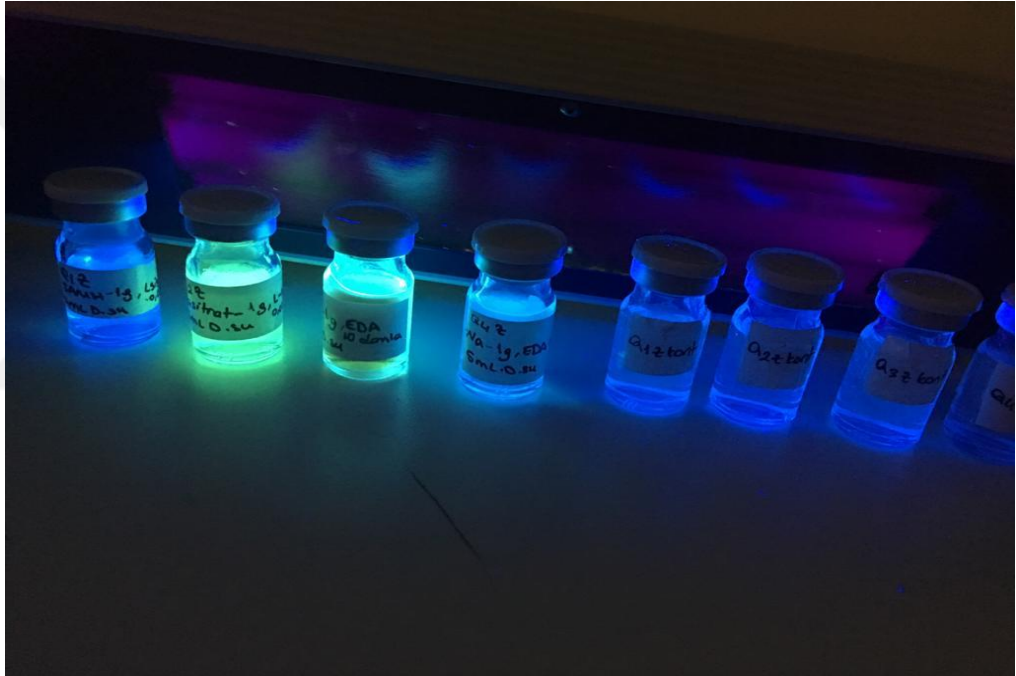
Resim 2: Karbon kuantum nokta örnekleri ve kontrol gruplarının UV cihazı altında görüntüleri.
