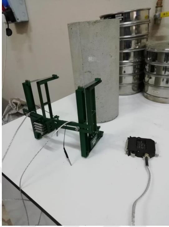
Şekil 3.12: Betonda elastisite modülü deneyi.
