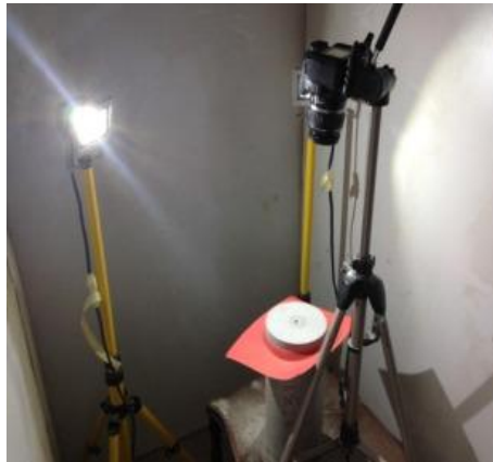
Şekil 6.10 Yüksek kaliteli görüntü elde edebilmek için kurulmuş kabin (Dogan, Arslan ve Ceylan, 2017)
