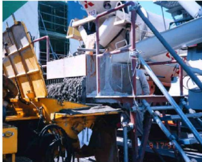
Şekil 4.11 Japonya Osaka LNG gaz tanklarının inşasında KYB kalite kontrolü için kullanılan deney aparatı (Okamura ve Ouchi, 2003)
