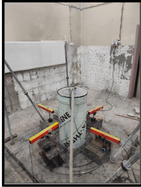
Şekil 4.39. D-H800 numunesinin deney düzeneğine yerleştirilmesi
