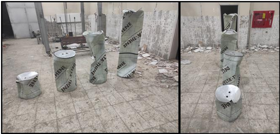
Şekil 4.52. Delta-Thene ile kaplanan silindirik tank numunelerinin son halleri
