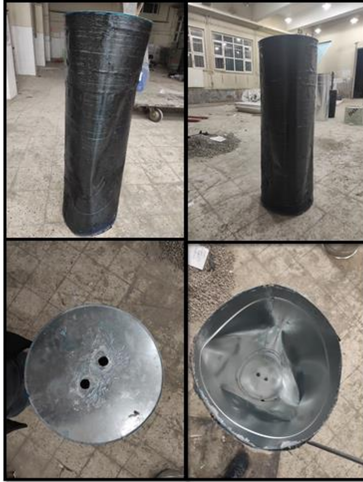
Şekil 4.26. Burkulma deneyi sonrası C-H1.200 numunesinin son hali
