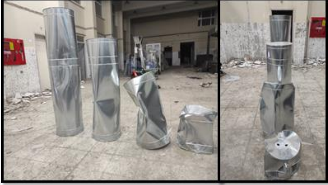
Şekil 4.17. Güçlendirilme veya kaplama yapılmayan silindirik tank numunelerinin son halleri.
