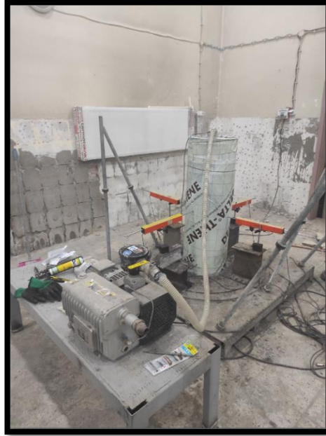
Şekil 4.43. D-H1.200 numunesinin deney düzeneğine yerleştirilmesi
