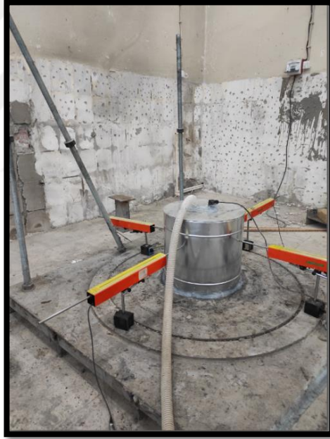
Şekil 4.1. B-H400 numunesinin deney düzeneğine yerleştirilmesi
