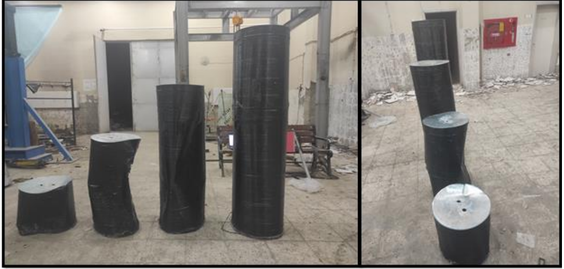
Şekil 4.34. CFRP ile güçlendirilen silindirik tank numunelerinin son halleri
