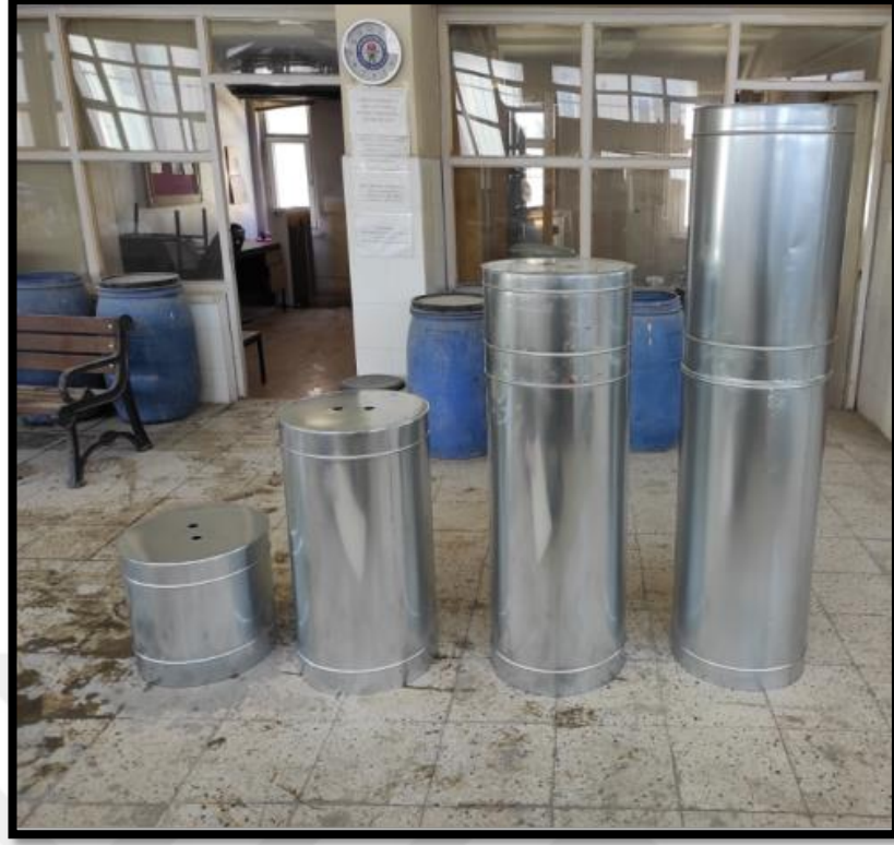
Şekil 3.5. Güçlendirme veya kaplama yapılmayan silindirik tank modelleri
