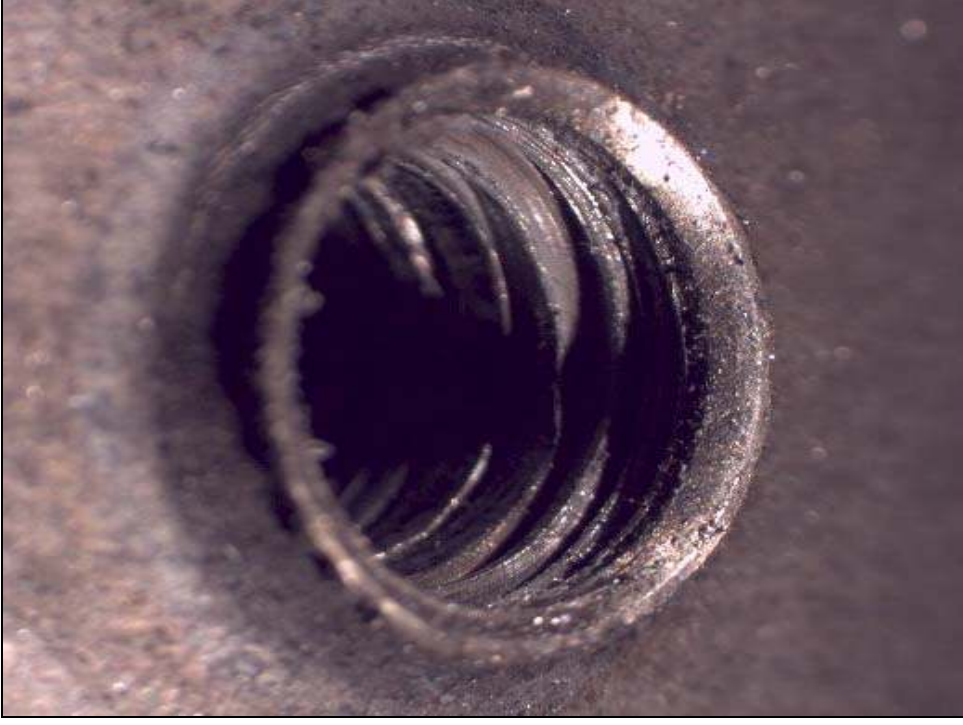
Resim 3.20. Çekme testi sonucu delik yüzeyinin makro görüntüsü [1]
