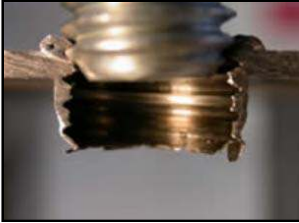
Resim 3.8. Sıvamadan sonra kılavuzla diş açılması [3]
