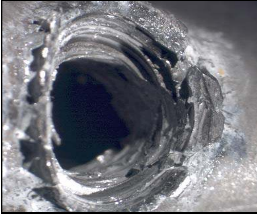
Resim 3.15. CM22NBK 2. test numunesinin sıyrılmadan sonraki makro yapısı [1]
