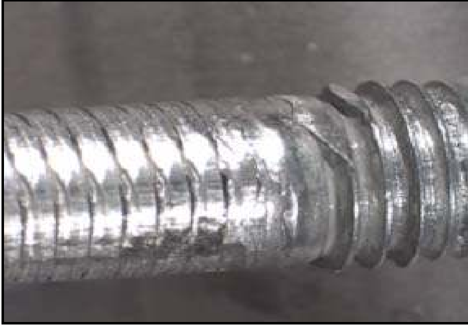
Resim 3.16. M8, 8.8 test civatasının sıyırılmadan sonraki makro yapısı [1]
