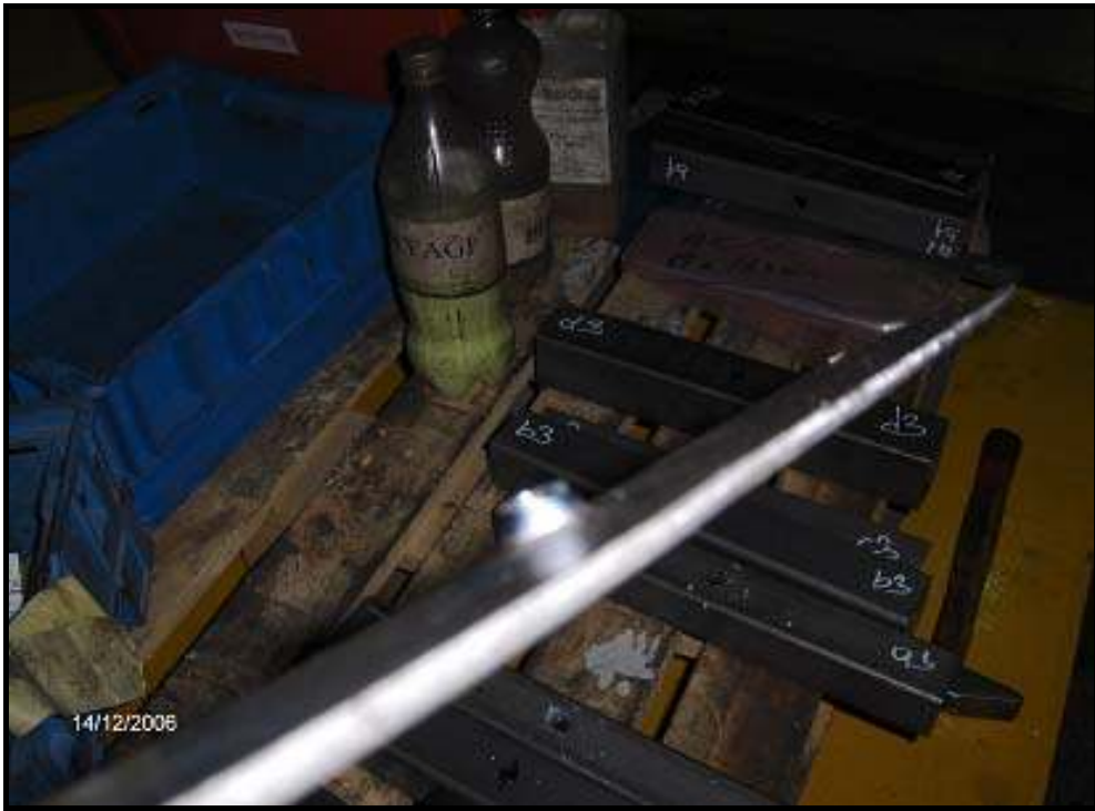
Resim 3.7. Sıvama işleminden sonra cıvata dişleri ile temas edecek yüzey [1]
