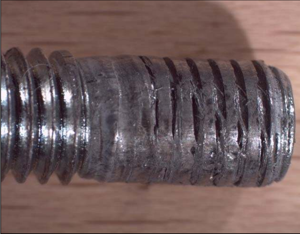
Resim 3.21. Çekme testi sonucu M8, 8.8 civatanın makro görüntüsü [1]
