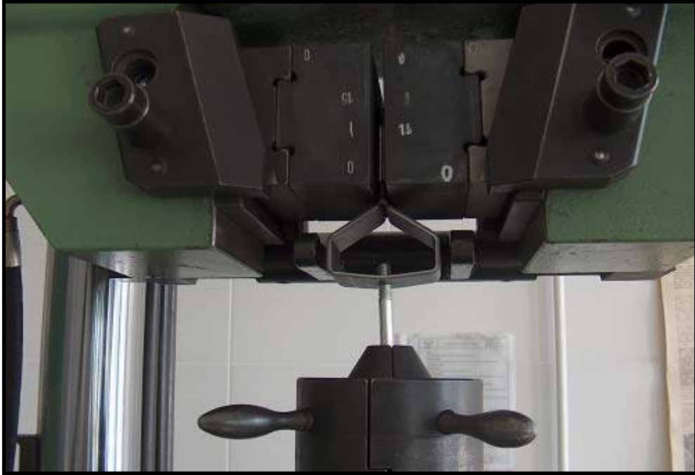
Resim 3.13. Özel tasarlanmış numunenin çekme testi [1]
