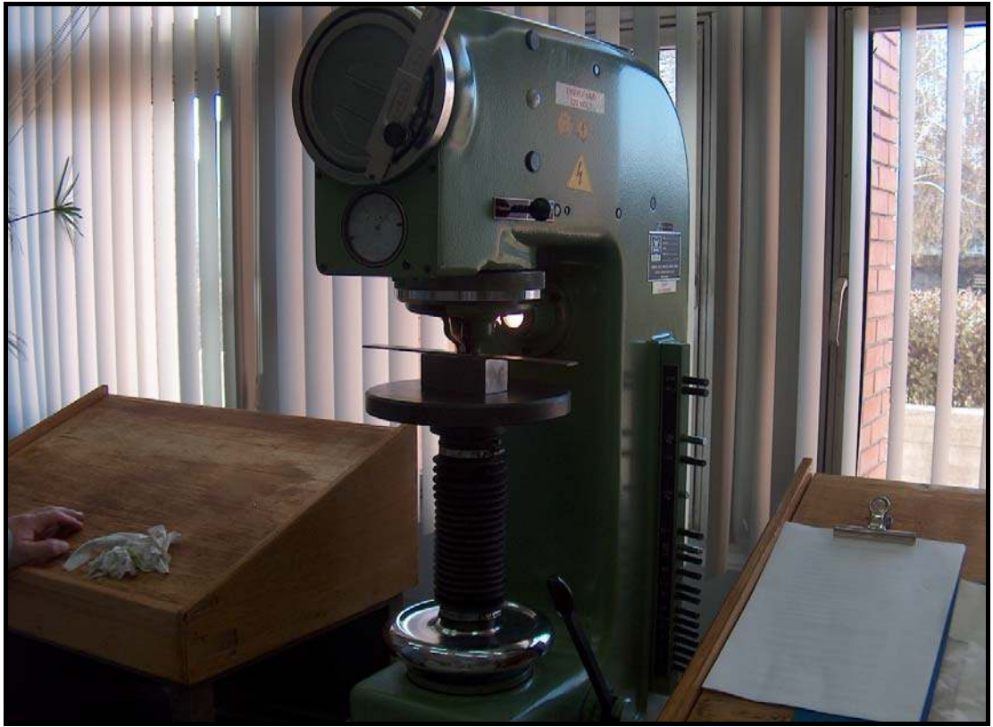
Resim 3.10. Rockwell sertlik cihazı [1]
