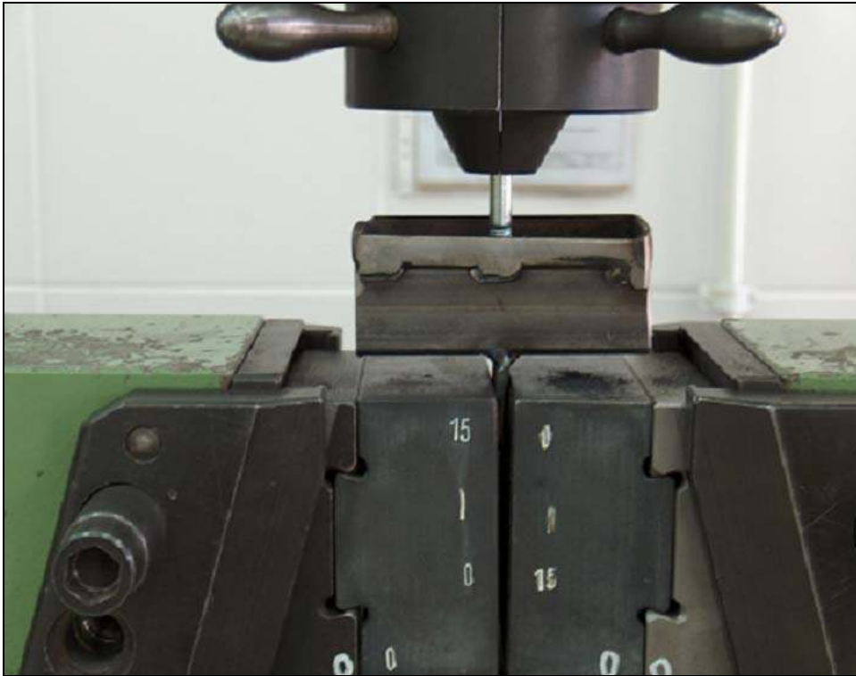
Resim 3.18. 2. tip test numunesinin çekme test cihazına bağlanması [1]
