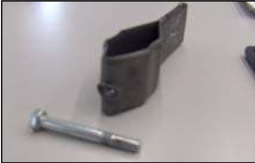
Resim 3.14. Civatanın malzemeden sıyrılmış hali [1]
