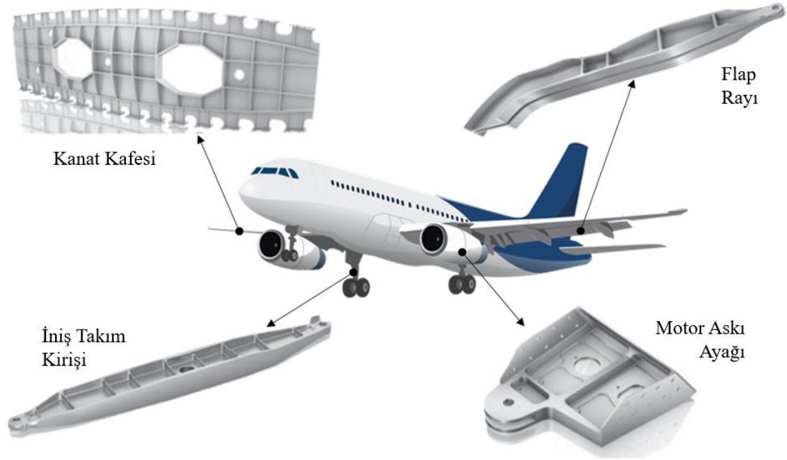
Resim 1.3 Bir uçakta kullanılan ince cidarlı parçalara dair örnekler (Dang vd. 2021).
