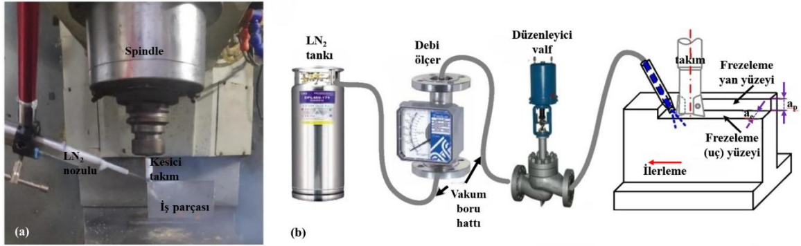
Şekil 2.6 (a) CNC freze deney düzeneği, (b) LN 2 'nin uygulanış biçiminin şematik gösterimi (Wang ve Wang 2023).
