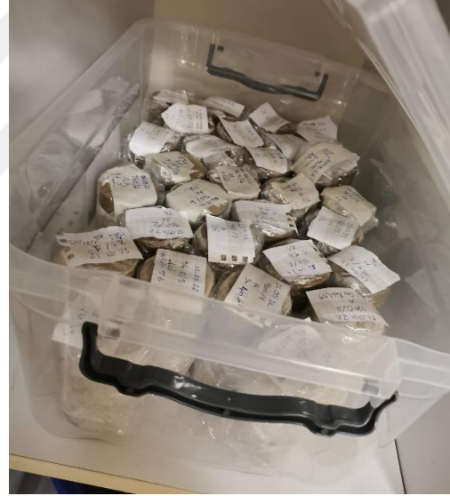
Resim 3.8 Zemin numunelerinin gerekli kür şartlarında saklanması.
