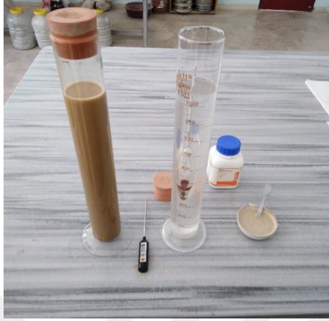
Resim 3.4 Dane boyutunun hidrometre deneyiyle tespit edilmesi.
