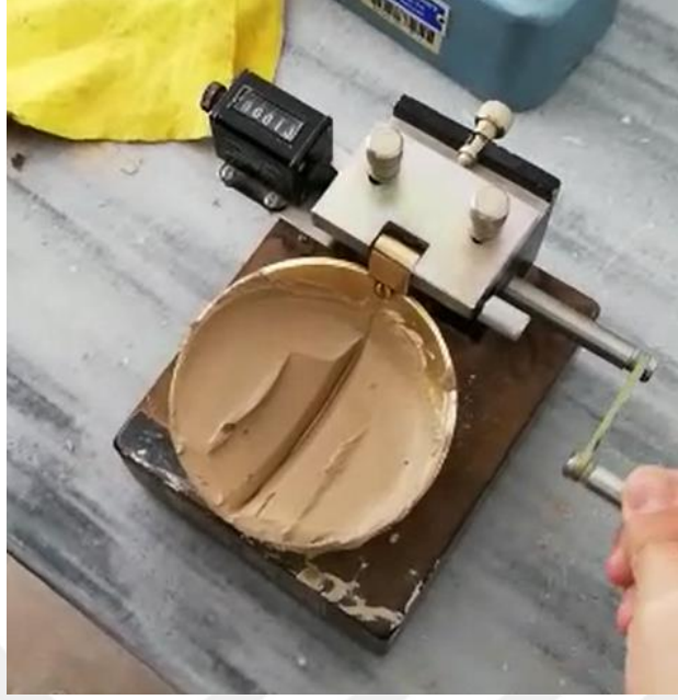
Resim 3.5 Casagrande deneyiyle likit limitin tespit edilmesi.
