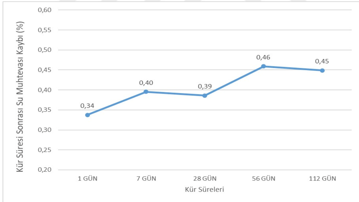
Şekil 4.19 Kür süresi boyunca su kayıplarının değerlendirilmesi.
