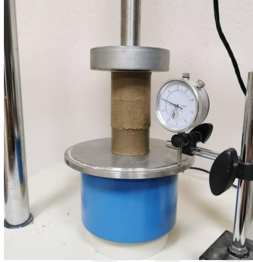
Resim 3.7 Zemin numunesinin serbest basınç deneyiyle dayanımının tespiti.
