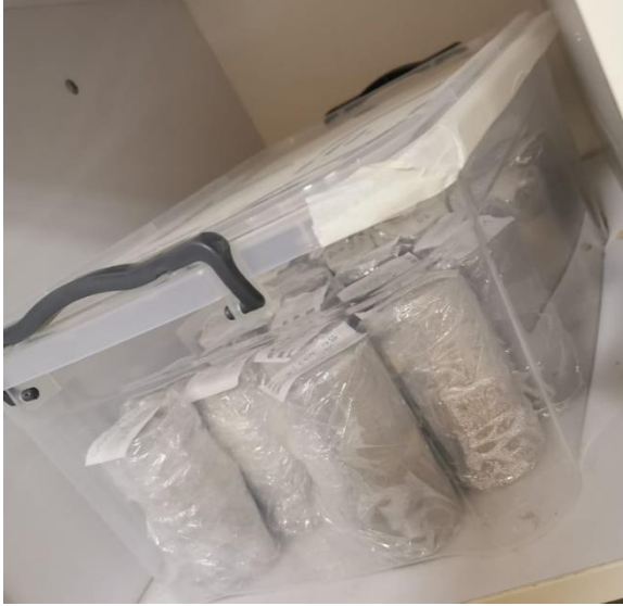
Resim 3.8 Zemin numunelerinin gerekli kür şartlarında saklanması.
