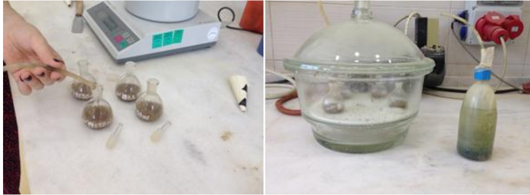
Şekil 4.12. Vakum öncesi numuneye su koyulması ve vakumlama aşaması
