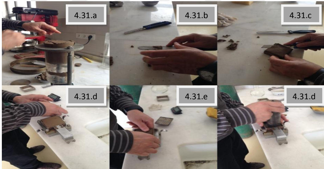
Şekil 4.31. Kesme kutusu deneyi için numunenin düzeneğe yerleştirilme işlemi
