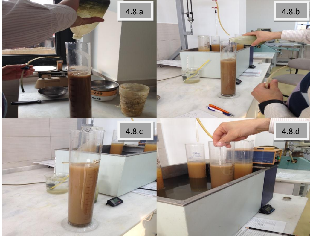
Şekil 4.8. Numunenin düzeneğe yerleştirilmesi ve hidrometre okumalarının alınması
