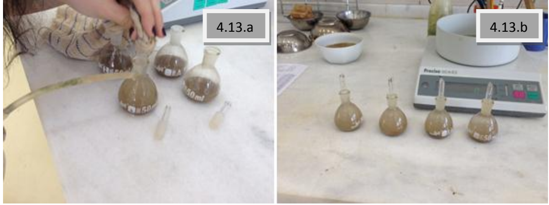
Şekil 4.13. Piknometre, numune ve su
