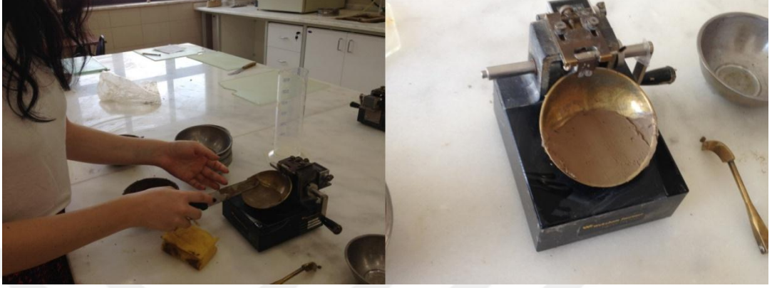
Şekil 4.1. Numunenin tas içine yerleştirilmesi
