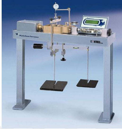
Şekil 2.10. Kesme kutusu deney düzeneği
