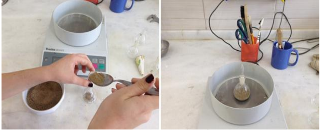
Şekil 4.11. Numunenin piknometreye koyulması ve tartılması
