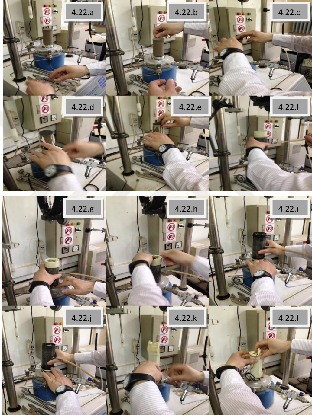
Şekil 4.22. Üç eksenli deney için numunenin hazırlanması işlemi
