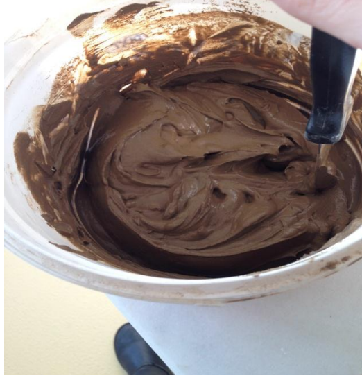
Şekil 4.17. Siltli kil deney numunesinin bulamaç haline getirilmesi
