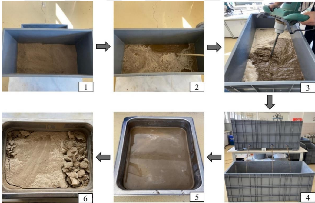
Şekil 3.4. Çöktürme tekniği uygulama aşamaları.
