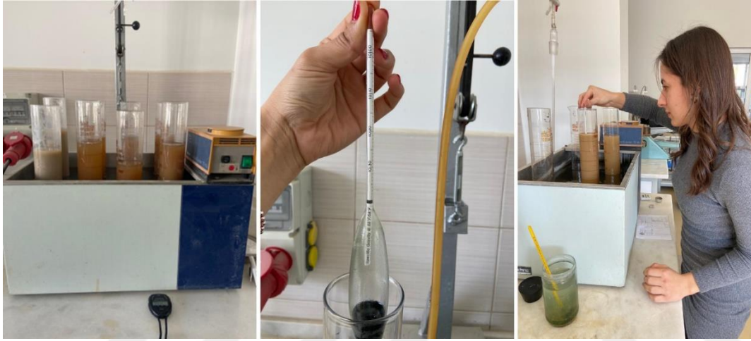
Şekil 3.21. Hidrometre okumalarının yapılması.
