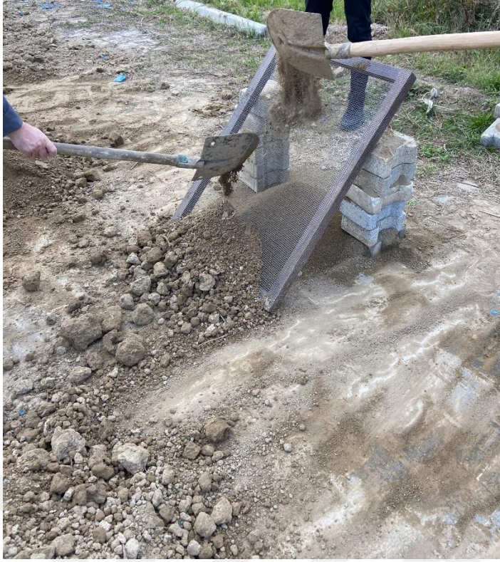
Şekil 3.1. Doğal siltli numunenin ön eleme işlemi.
