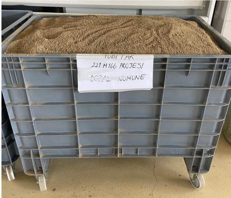
Şekil 3.2. Eleme sonrası elde edilen doğal numune.
