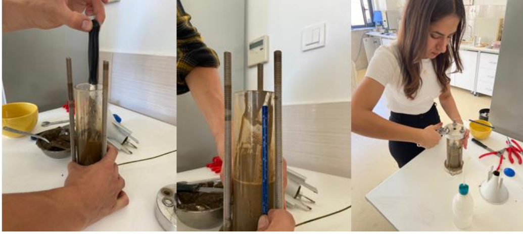
Şekil 4.2. Bulamaç numunesinin plexiglass tüpüne yerleştirilmesi.
