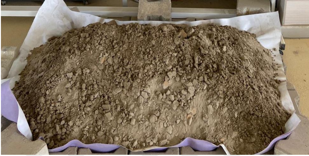
Şekil 3.5. Çöktürme işlemi sonrası elde edilen sıfır numunesi.
