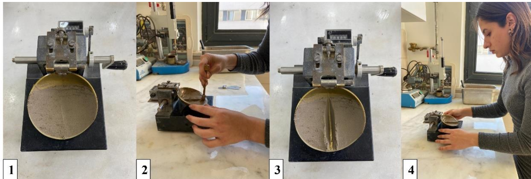
Şekil 3.9. Casagrande deneyinin aşamaları.
