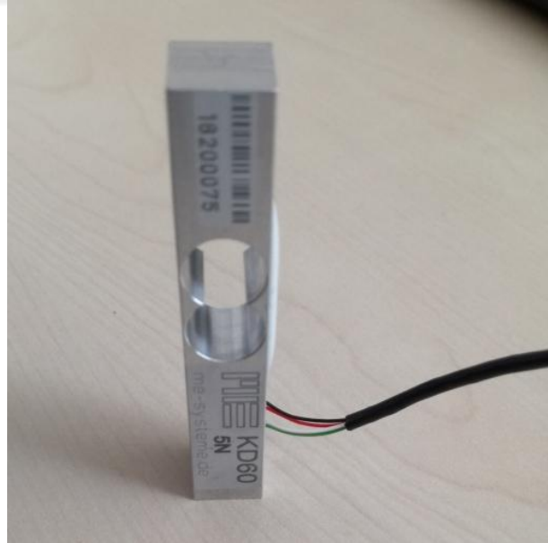
Resim 2.5. Kuvvet ölçüm sisteminde kullanılan yük hücresi.
