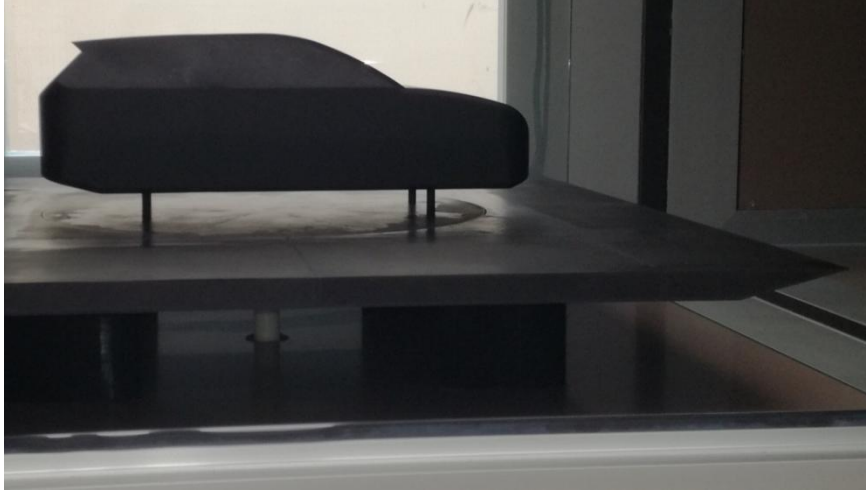
Resim 2.12. Döner tablaya dört adet silindirik bacak ile sabitlenen crossover taşıt modeli.
