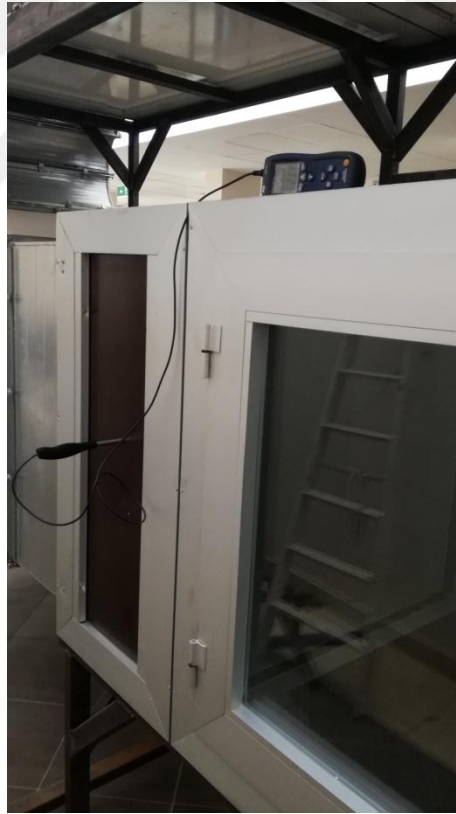
Resim 2.2. Test bölgesinde kızgın-tel anemometresi ile serbest-akım hızı ölçümü.
