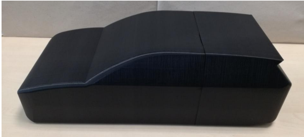
Resim 2.11. Üç-boyutlu yazıcı ile iki parça halinde basılmış 1:10 ölçekli crossover taşıt modeli.
