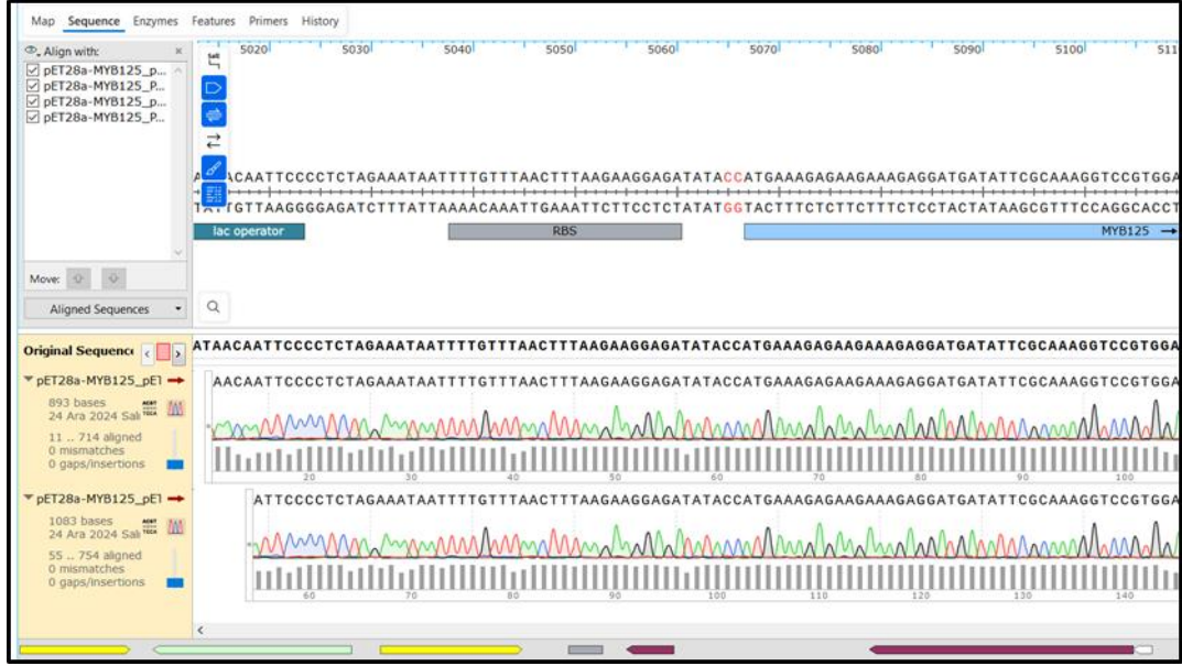
Şekil 3.6. pET-28a(+)-FcMYB125 rekombinant plazmidinin 5' birleşme bölgesinin Sanger doğrulaması. Üst panelde lac operatörü, RBS ve MYB125 ORF başlangıcı (ATG) gösterilmiştir. Alt panelde ileri ve geri okumalar referansla örtüşmekte; RBS→ATG geçişi ve ORF'nin in-frame başladığı doğrulanmaktadır.
