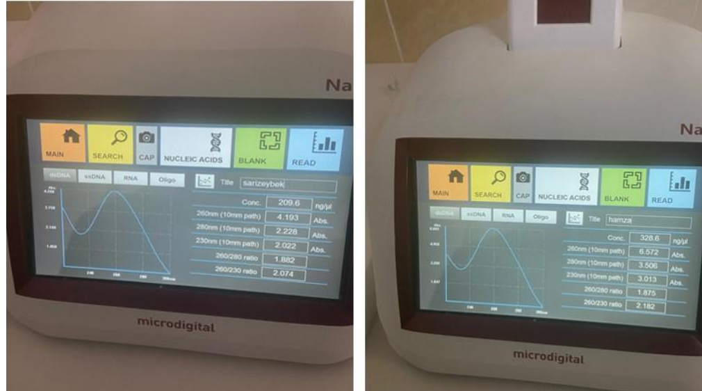
Şekil 3.15. Sarı Zeybek ve Hamza ilek incir çeşitlerine ait DNA saflık ve yoğunluk değerlerinin Nano-300 MicroDigital cihazı ile ölçüm çıktıları.
