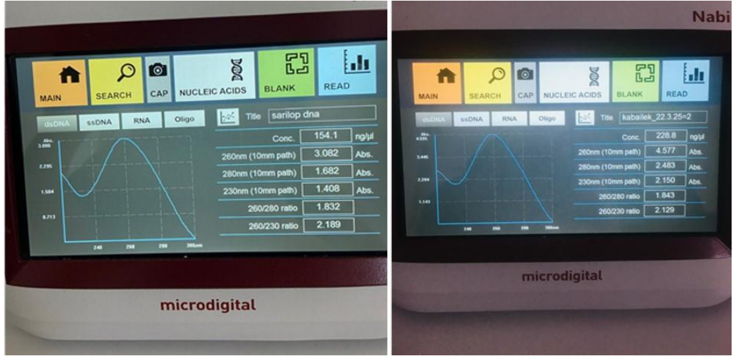
Şekil 3.14. Sarılop ve Kaba ilek incir çeşitlerine ait DNA saflık ve yoğunluk değerlerinin Nano-300 MicroDigital cihazı ile ölçüm çıktıları.
