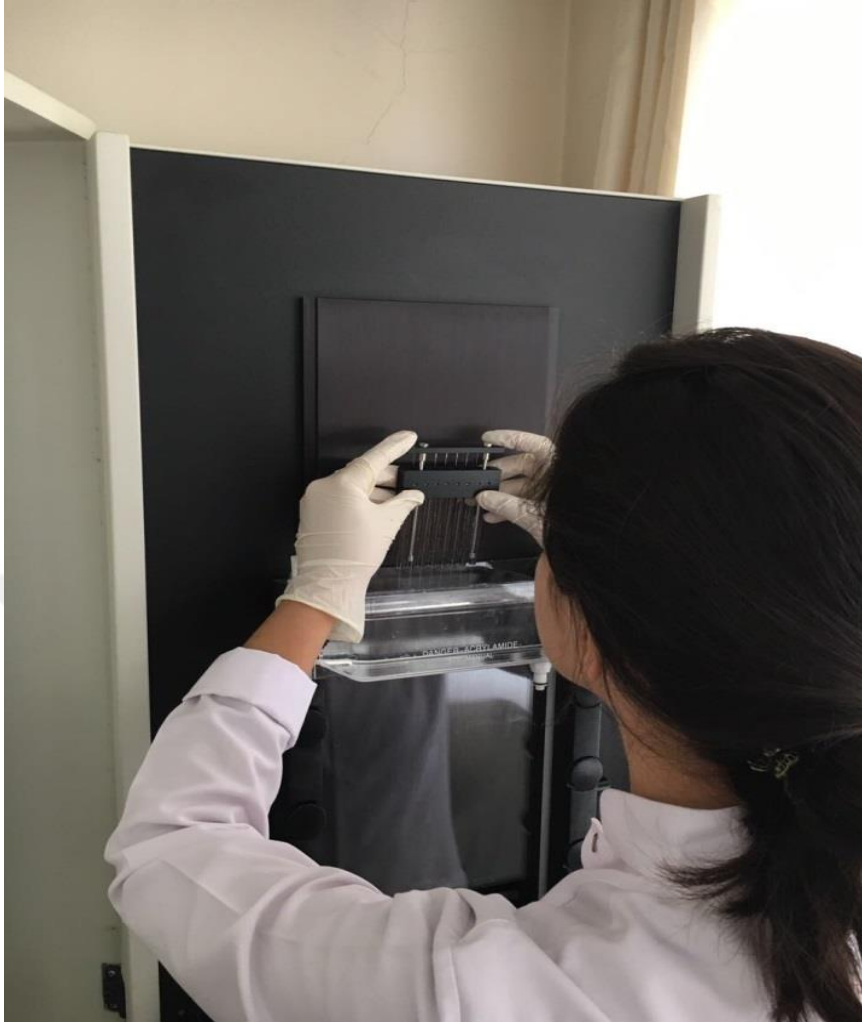
Şekil 3.4. Denatüre edilmiş PZR ürünlerinin poliakrilamit jele yüklenmesi
