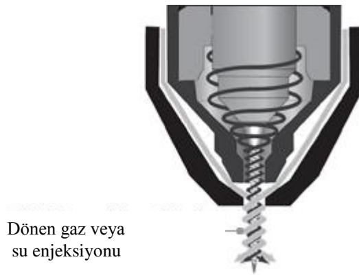
Şekil 4.17 Dönen gaz plazma kesim sisteminin şematik gösterimi [108].
