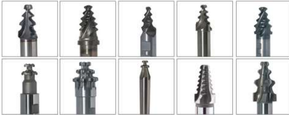
Resim 2.9. Kök geometrisi frezeleme için üretilen freze takımları [22]
