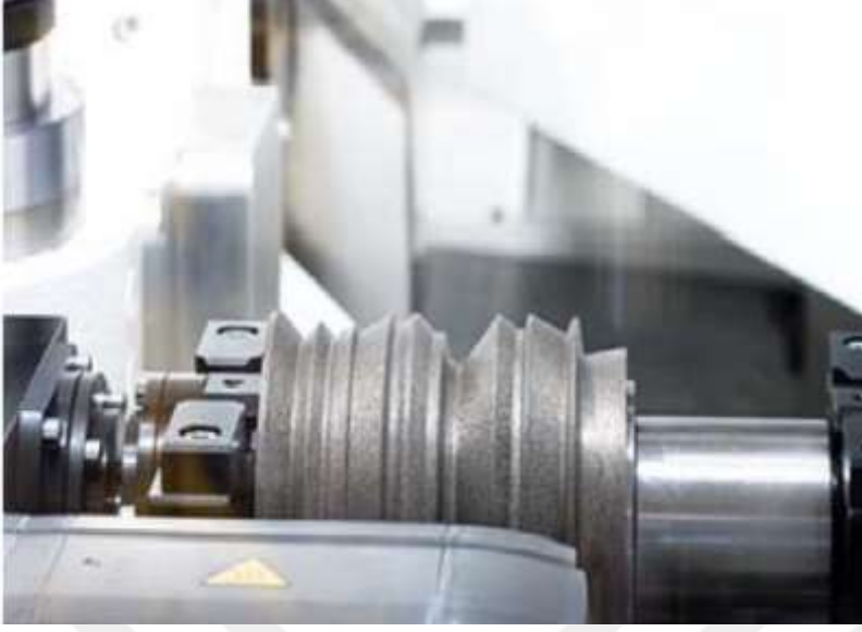
Resim 2.12. Parça özelinde hazırlanmış masa bileyiciler grubu [28]
