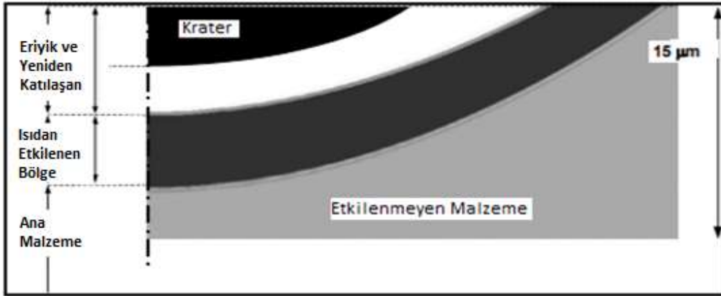
Resim 2.8. EDM sonrası faz değişimleri [18]
