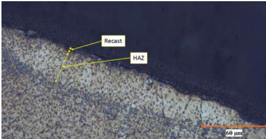
Resim 4.16. Dağlama sonrası örnek yeniden katılaşan ve ısıdan etkilenen bölge görüntüsü
