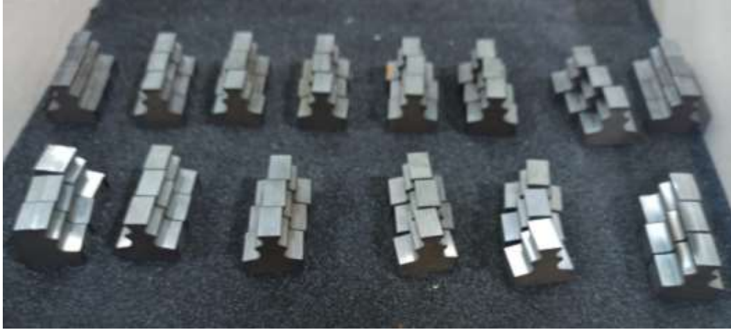
Resim 4.11. Bakalite alınacak numuneler
