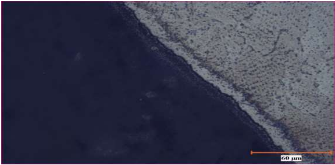
Resim 4.18. Örnek yarıçap bölgelerindeki yeniden katılaşan ve ısıdan etkilenen bölge oluşumları
