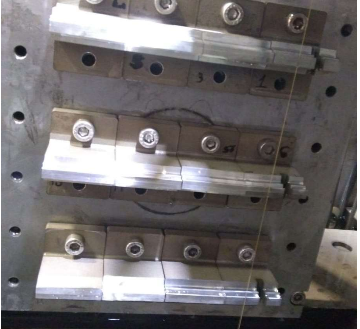
Resim 3.19. Numunelerin tel erozyon tezgahı ile kesilmesi
