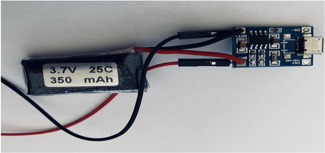
Şekil 3.24 Lipo Pil ve TLP4056
