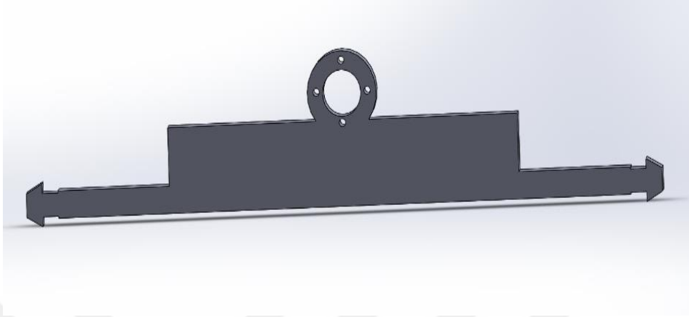
Şekil 4.2 Vidalı somun braket
