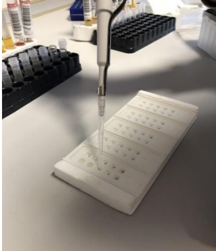
Şekil 34. Trayın üzerindeki kuyucuklara dilüe örneğin pipetlenmesi.
