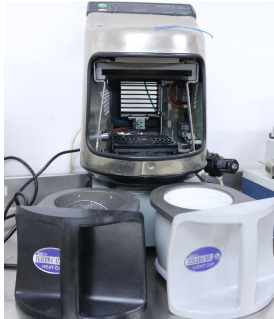
Şekil 3-29: Tescera Fırında İndirekt Kompozit Çubukların Polimerizasyon İşleminin Tamamlanması
