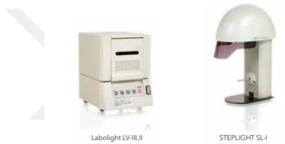
Şekil 3-26: Gradia Labolight ve Steplight Cihazları İle İndirekt Kompozit Çubukların Polimerizasyon İşleminin Tamamlanması
