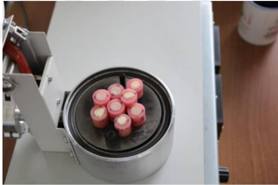
Şekil 3-51: SEM İçin Numunelerin Au-Pd İle Kaplanması İçin Dizilmiş Hali
