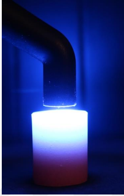
Şekil 3-10: Mikrohibrit Z250 Kompozit Polimerizasyon Aşaması
