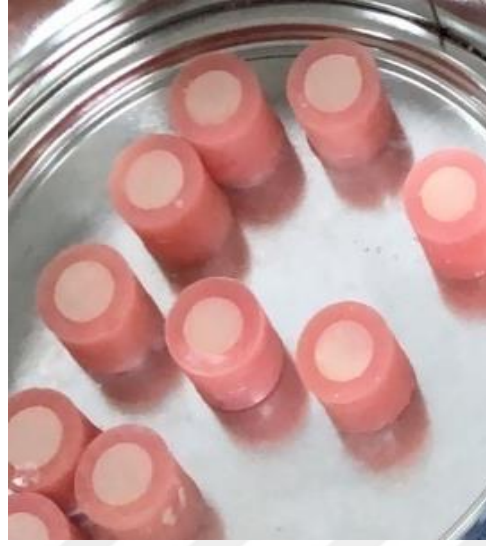
Şekil 3-12: Hazır Akrilik Bloğun İçerisine Z250 Mikrohibrit Kompozitin Polimerize Edilmiş Hali
