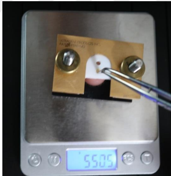
Şekil 3-47: Hassas Tartı İle Standart Bir Ağırlığın Çubuklara İletilmesi
