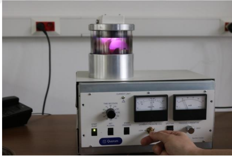
Şekil 3-53: SEM İçin Rastgele Seçilmiş Örneklerin Au-Pd İle Kaplanma Cihazına Yerleştirilip Kaplanma İşleminin Tamamlanması
