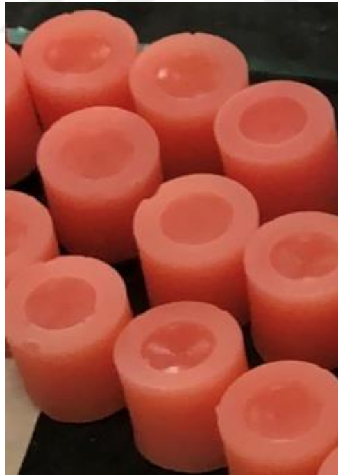
Şekil 3-11: Silikon Kalıptan Elde Ettiğimiz Otopolimerizan Akrilik Bloklar
