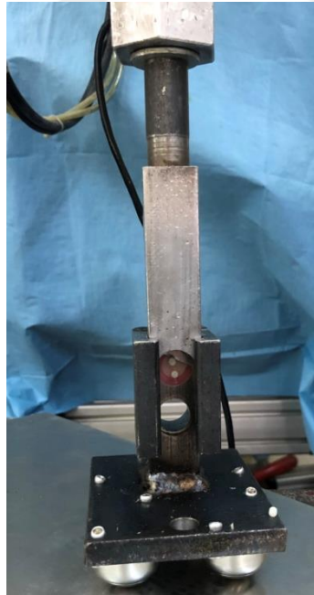
Şekil 3-49: Shearbond Test Cihazında Örneklerin Kırılma Aşamaları
