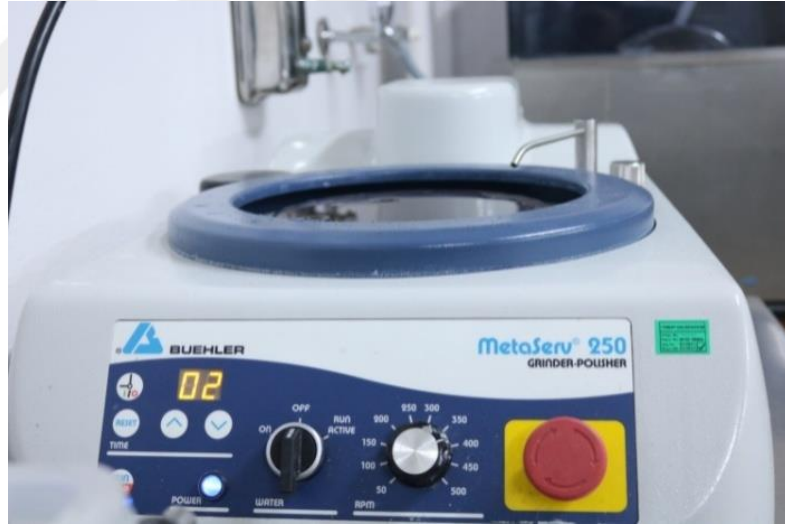
Şekil 3-13: Standart Yüzey Elde Edilmesi İçin Metaserv Zimparalama Aleti İle Diş ve Z250 Kompozit Örneklerin Hazırlanması
