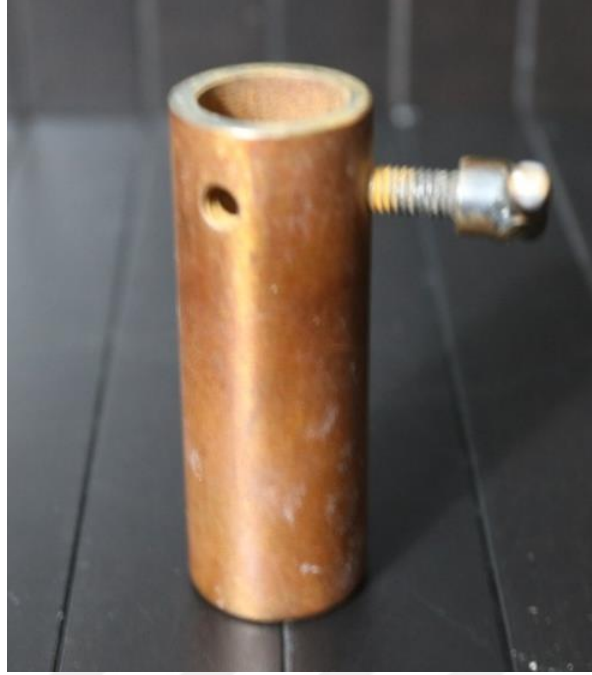
Şekil 3-14: Diş ve Z250 Mikrohibrit Kompozitten Elden Edilen Örneklerin Zimparalanmasında Tutmayı Kolaylaştırmak İçin Tasarlanan Metal Torna
