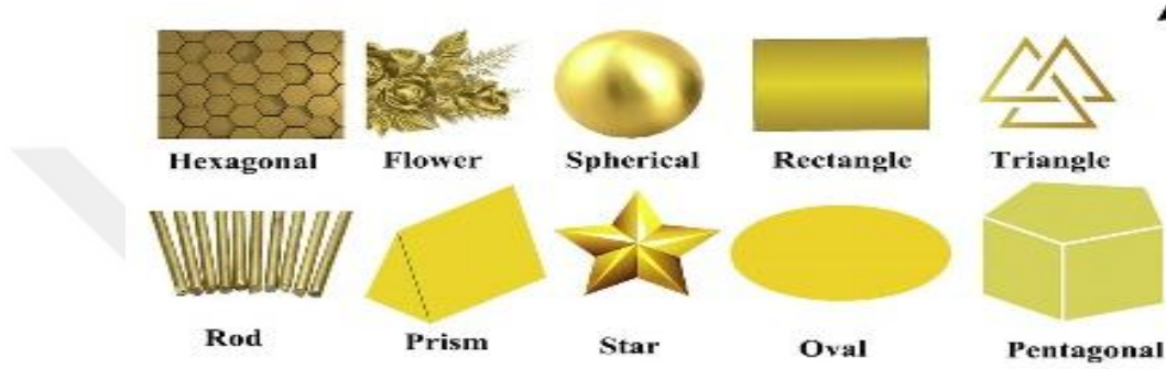
Şekil 2.5. Farklı şekillerdeki altın nanopartiküller (Ramalingam, 2019).
