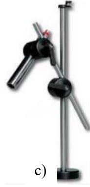
Şekil 6.9. Ultra yüksek frekanslı indüksiyon ısıtma sistemi a) indüksiyon kaynağı ve kontrol ünitesi, b) İndüksiyon bobini, c) infrared pirometre
