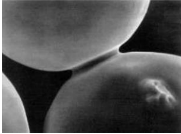
Şekil 3.8. Nikel tozunun sinterlemesi sırasında boyun oluşumu (Yönetken, 2008)
