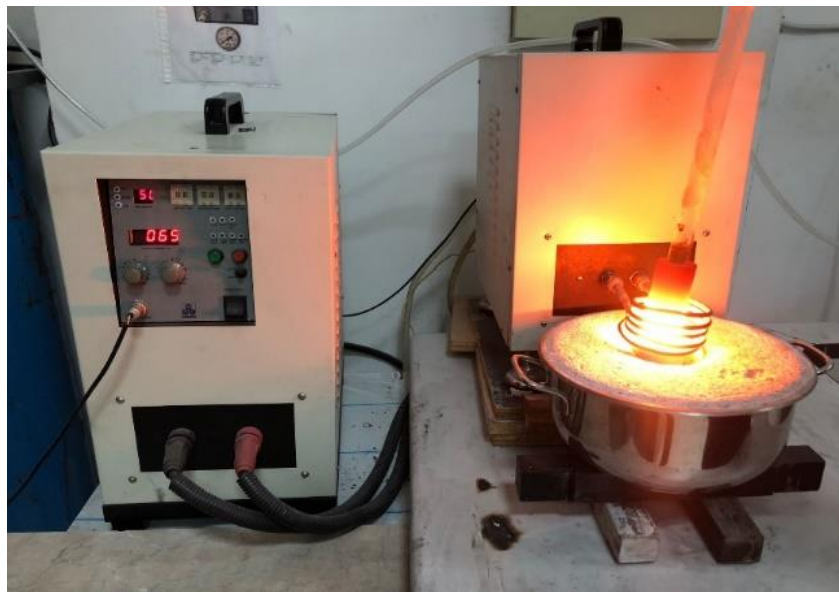
Şekil 6.5. İndüksiyonla sinterleme düzeneği
