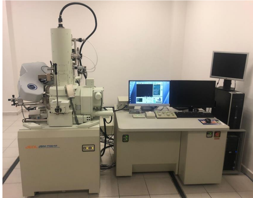
Şekil 6.10. Jeol marka JSM7001F model SEM cihazı
