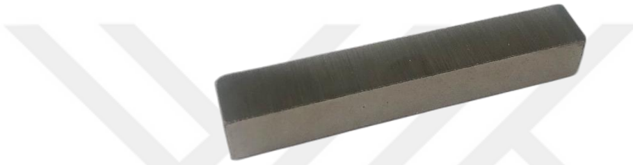
Şekil 6.2 AISI 316L Paslanmaz çelik soğuk preslenmiş numune
