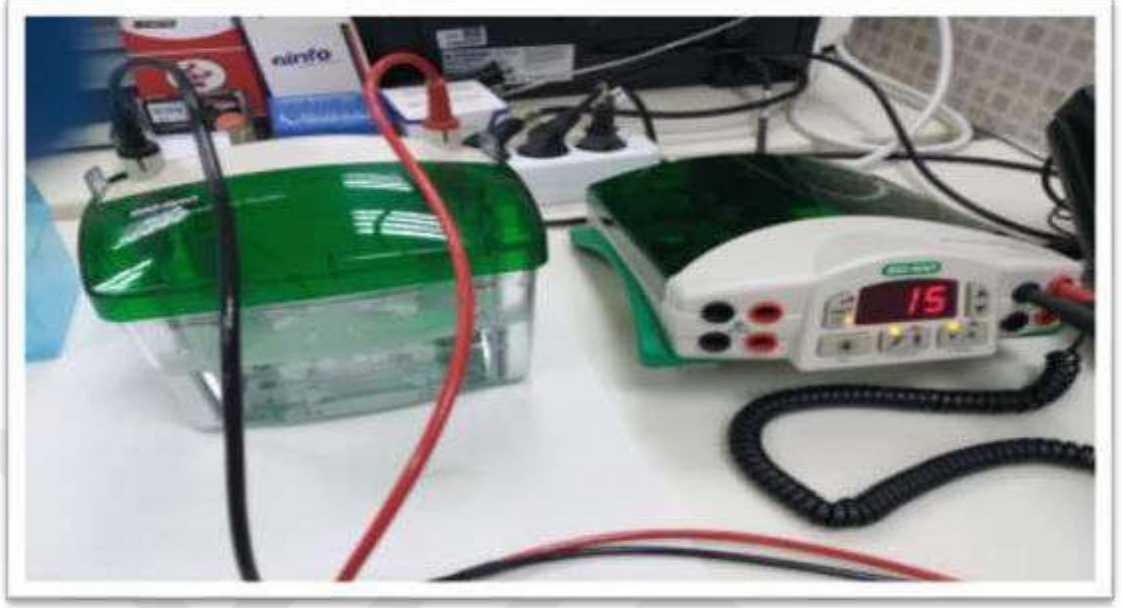
Resim 2. SDS-PAGE elektroforezi jel yürütme işlemi
