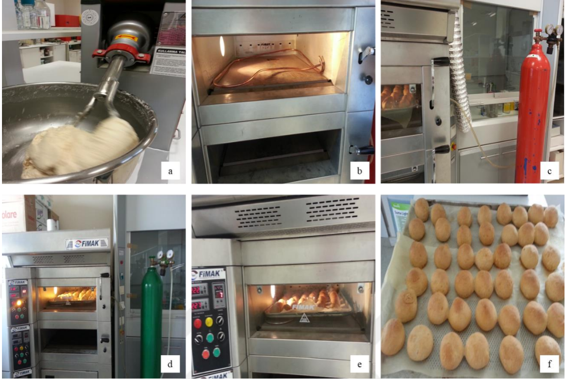
Şekil 3.1. Deneme ekmeklerinin üretimi. a) Ekmek hamurunun yoğurulması; b) Fırın içine yerleştirilen gaz kanalı; c) Farklı gaz ortamında pişirme (karbondioksit gazı) d) Farklı gaz ortamında pişirme (Azot gazı) e)Pişirme ortamı f) Elde edilen roll ekmekler
