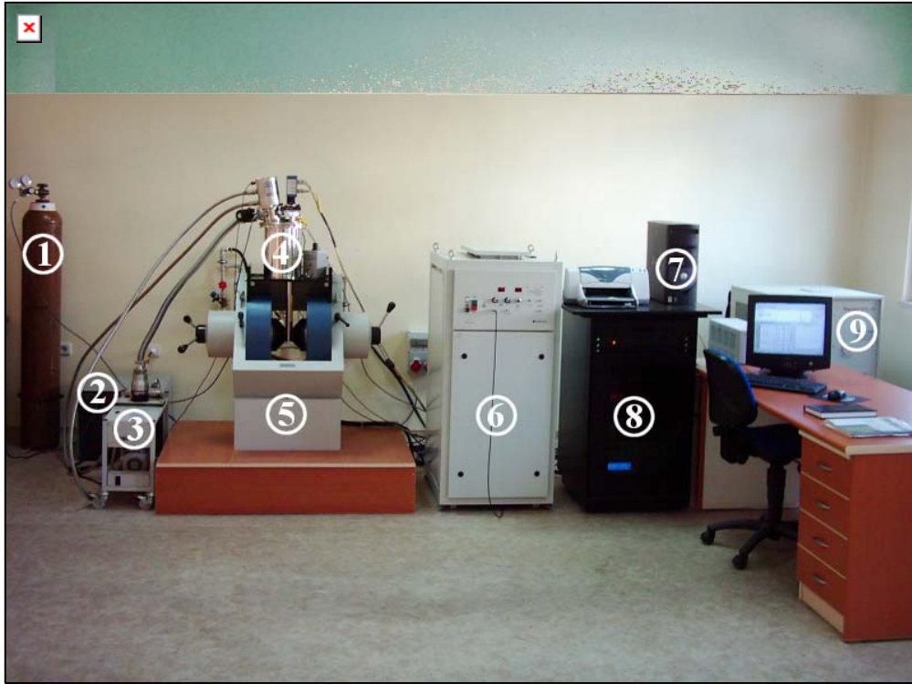
Resim 4.1. Lakeshore 7700A tipi Yüksek Empedans Hall etkisi sistemi (1) He tüpü.(2) Kapalı devre He soğutma ünitesi, (3) Vakum pompası, (4) Kryostat, (5) Magnet sistemi, (6) Magnet güç kaynağı, (7) Bilgisayar, (8) Sıcaklık kontrol ünitesi, ölçüm cihazları, anahtarlama sistemi, manyetik alan ölçüm sistemi vb... içeren enstrüman dolabı, (9) Su soğutma sistemi
