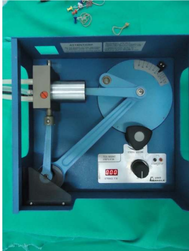
Şekil 17: İnhalasyon anestezisinde kullanılan ventilatör
