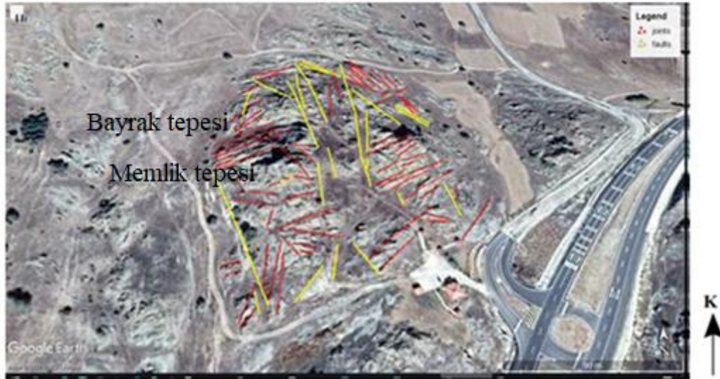
Şekil 6: Tıkaçlarda gelişen fay ve çatlaklar sistemi. (Kocak 2021)
