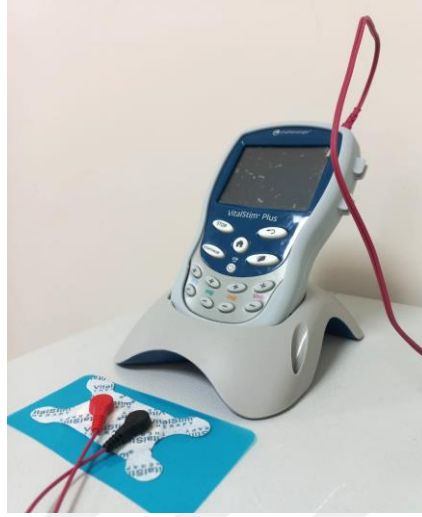
Görsel 4. Nöromusküler elektrik stimülasyon cihazı ve kullanılan elektrod
