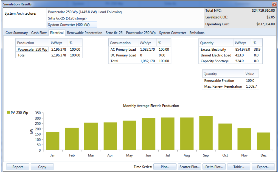
Şekil 5.8 Aylık ortalama elektrik üretimi
