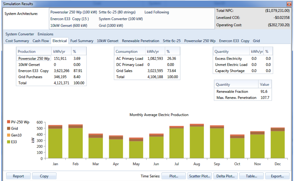
Şekil 5.41 Aylık ortalama elektrik üretimi
