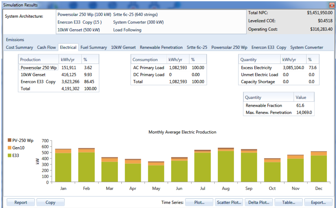
Şekil 5.19 Aylık ortalama elektrik üretimi
