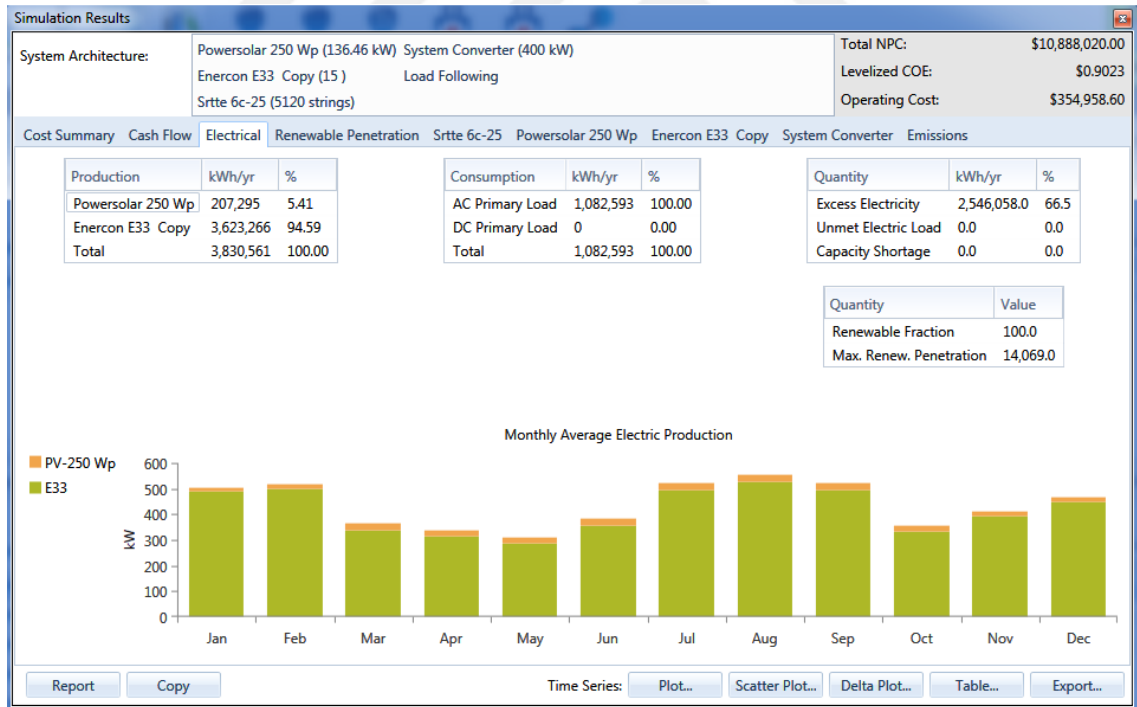
Şekil 5.13 Aylık ortalama elektrik üretimi
