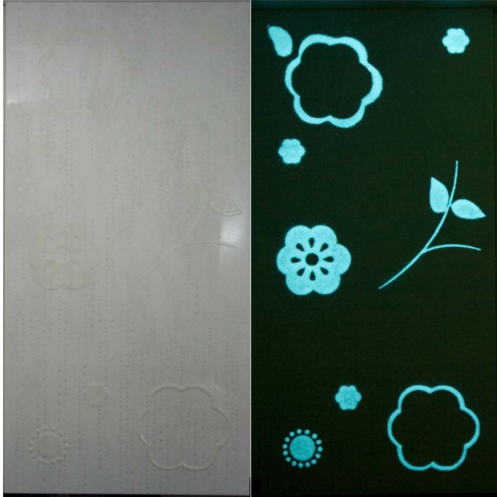
Şekil 13.19. % 10 mavimsi-yeşil fosforesans pigment içeren S1B firiti ile yapılan desen çalışması.
