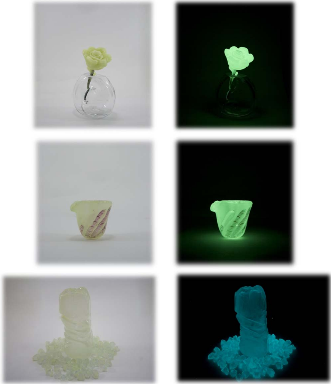
Şekil 14.2. Cam objeler üzerine soğuk dekorlama yöntemi ile yapılan fosfor uygulamaları.
