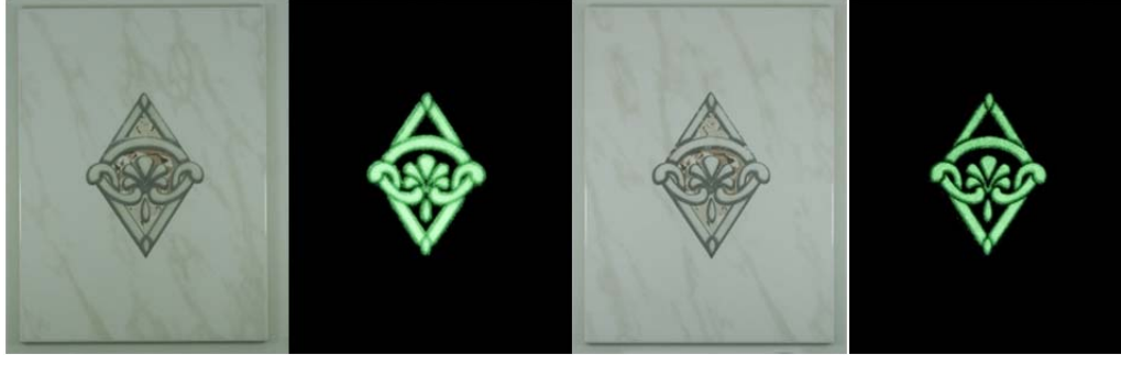
Şekil 13.16. Vitra Karo A.Ş.'de 920 °C'de (a) 40 dk ve (b) 35 dk süreyle pişirimi yapılan sarımsı-yeşil ışıldamalı duvar karosu bünyelerine ait aydınlık ve karanlık ortam görüntüleri.
