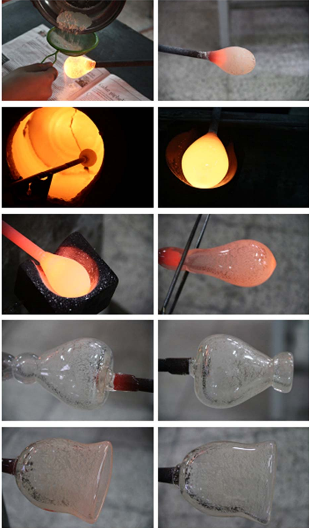
Şekil 9.4. Sıcak cam üfleme yöntemi ile fosfor ısıldamalı cam üretimine ait fotoğraflar.
