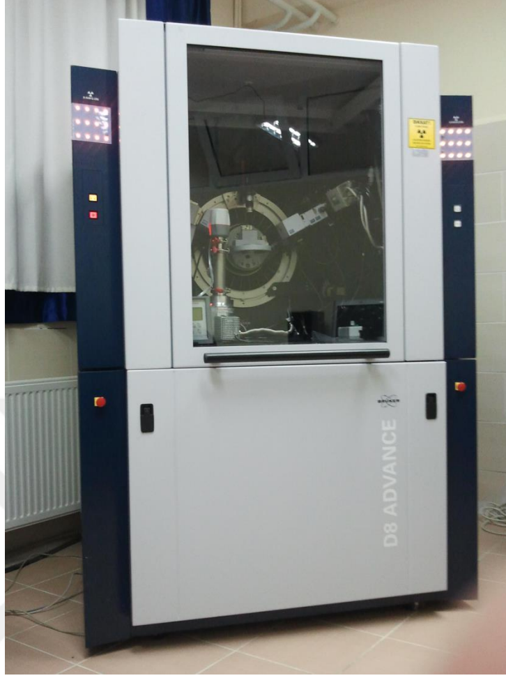
Resim 5.14 XRD Analiz Cihazı.
