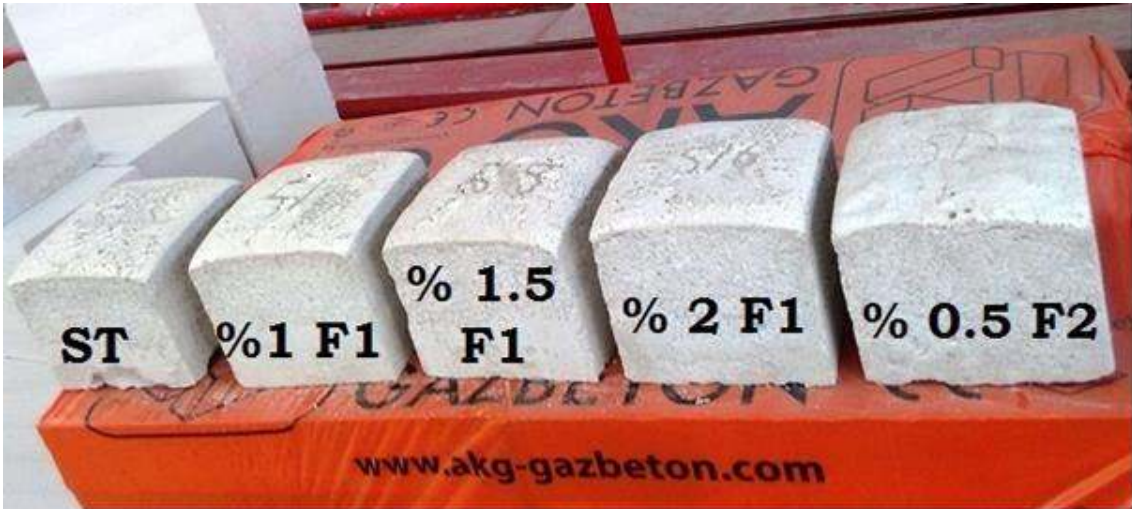
Resim 5.9 ST ve Farklı Oranlarda F1 ve F2 İçeren Cam Fiber Katkılı Küçük Kalıp Denemeleri.
