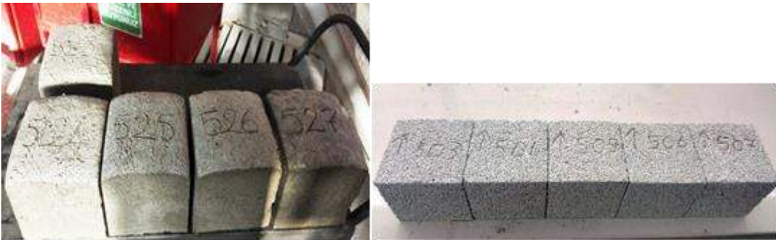
Resim 5.11 BD –Yoğunluk ve A Faktörü Analizleri Numune Koşullandırma.
