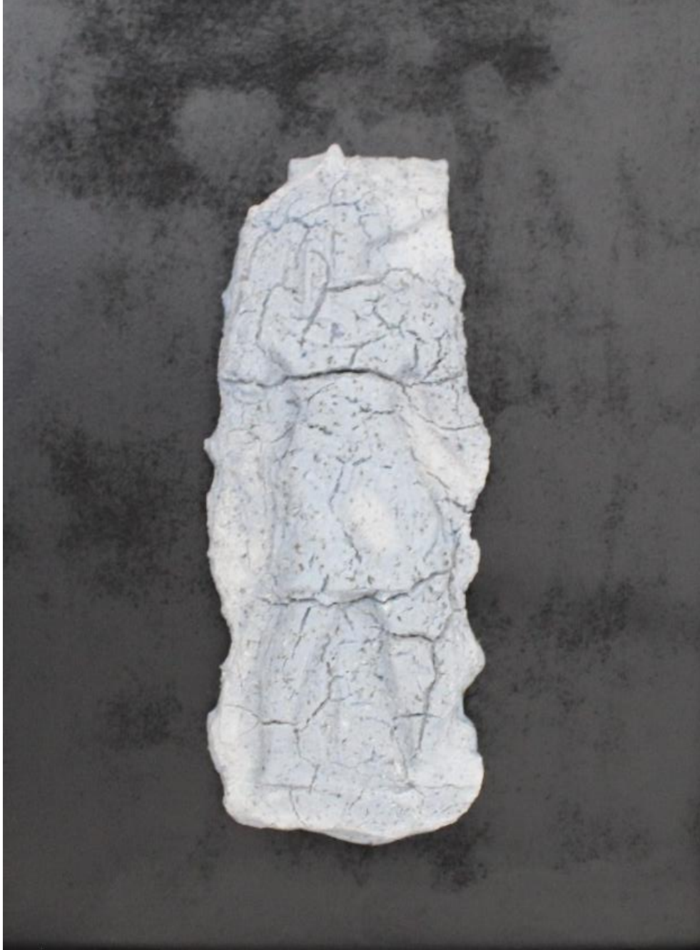
Görsel 48: İnorganik katı atıklardan beyaz meyve suyu şişesi cam tozu ve anahtar tozu katkılı Mısır pastası bünye (Reçete A11-11), Anubis Figürini, 23x9x2.5 cm, 950 °C, (Özlem Sağlıyan Sönmez, 2024)
