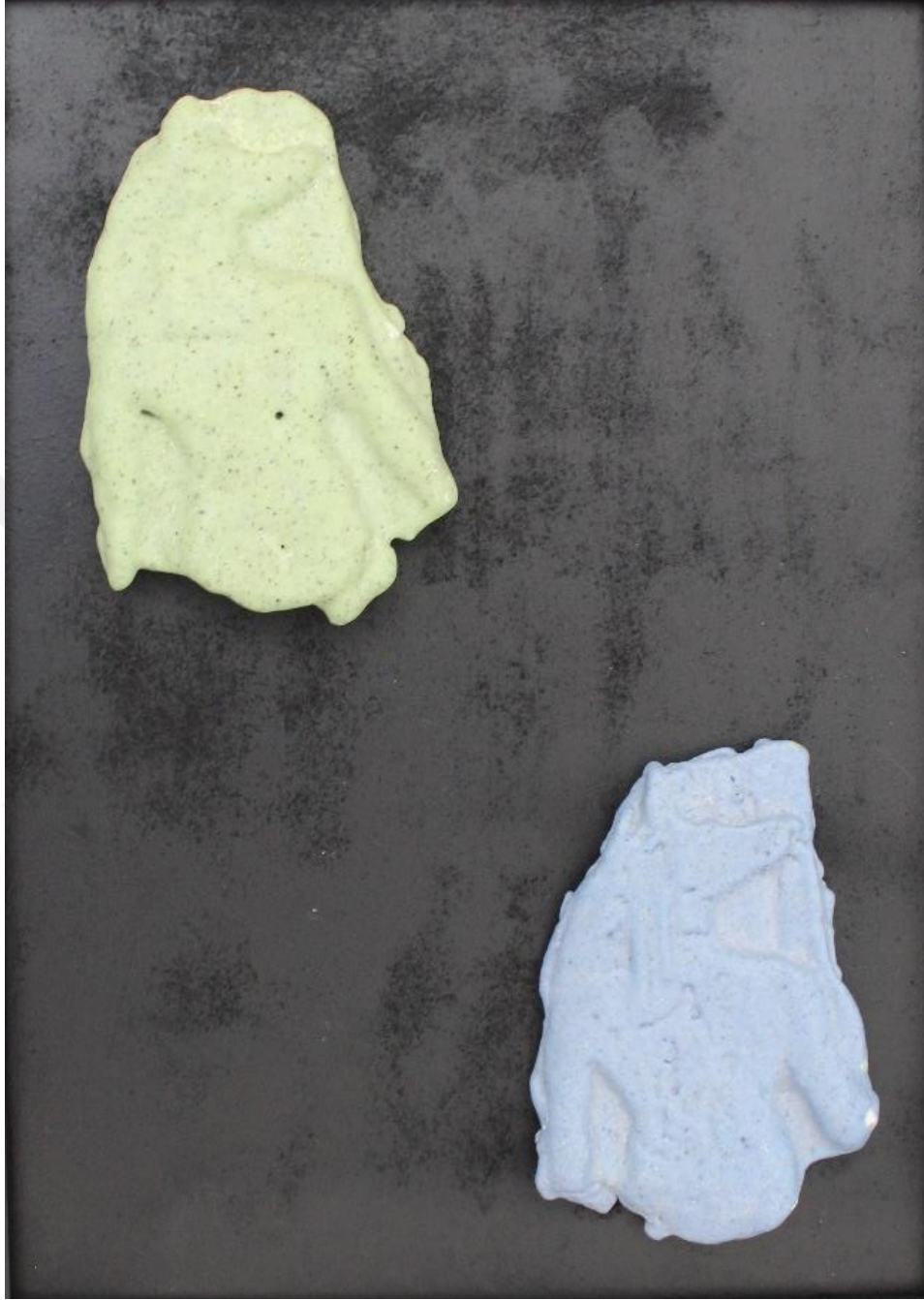
Görsel 53: İnorganik katı atıklardan mavi soda şişesi ve yeşil soda şişesi cam tozları katkılı Mısır pastası bünye (Reçete A11-1, A11-3), Anubis Figürinleri, 12x9x2.5 cm, 950 °C, (Özlem Sağlıyan Sönmez, 2024)
