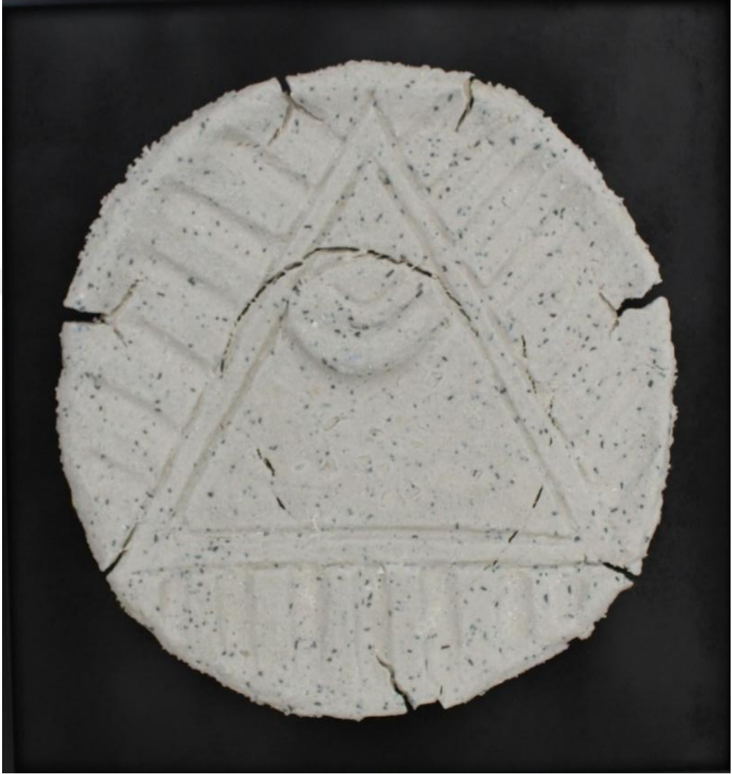
Görsel 52: İnorganik katı atıklardan beyaz meyve suyu şişesi cam tozu ve pirinç tozu atığı katkılı Mısır pastası bünye (Reçete A11-12), Ra'nın Gözü Tabak, R:23 cm, 950 °C, (Özlem Sağlıyan Sönmez, 2024)
