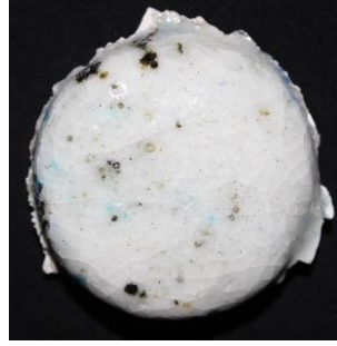
Görsel 41: B7-3 kodlu deney örneği (1050°C)
