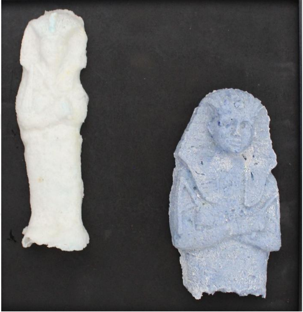
Görsel 54: İnorganik katı atıklardan mavi soda şişesi ve beyaz meyve suyu şişesi cam tozu katkılı Mısır pastası bünye (Reçete A11-5, A11-3), Tutankhamun Figürini, 14x5-12x6 cm, 950 °C, (Özlem Sağlıyan Sönmez, 2024)
