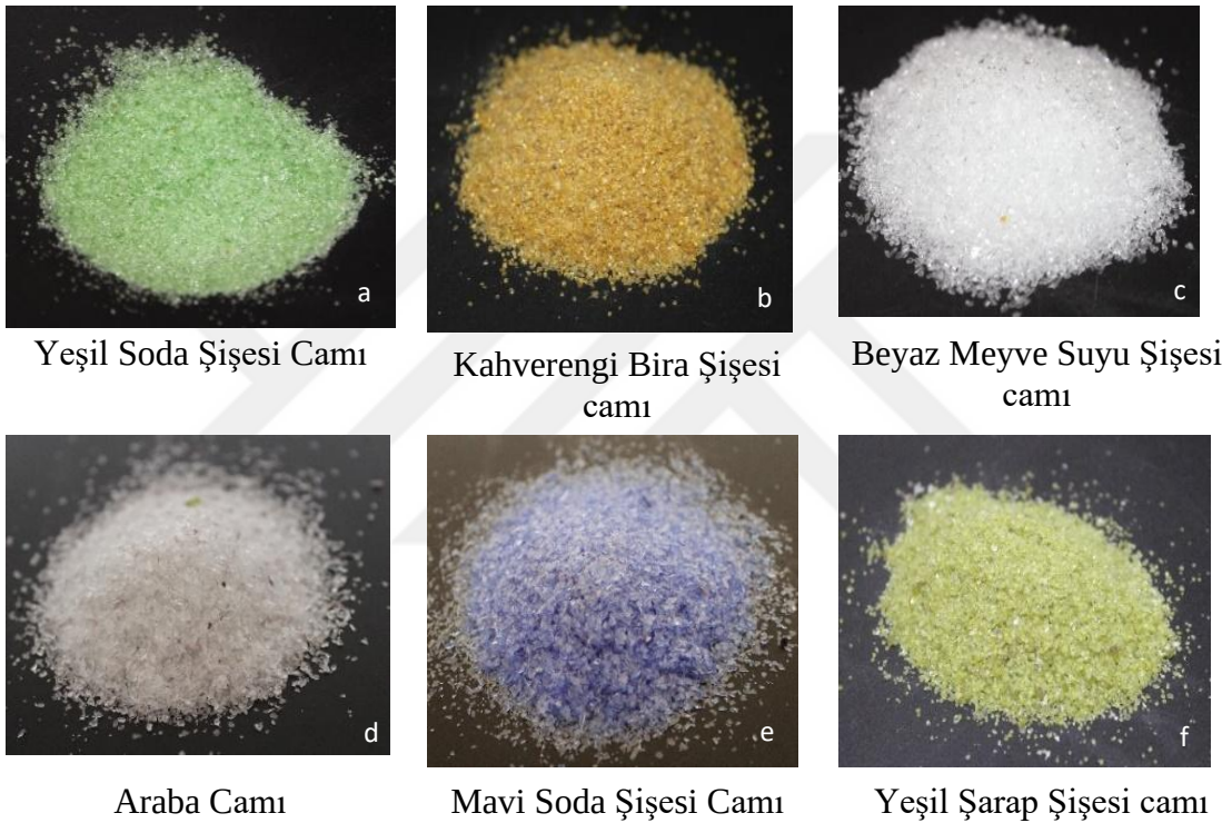
Görsel 29: Cam atıklar: a) Yeşil Soda Şişesi Camı; b) Kahverengi Bira Şişesi Camı; c) Beyaz Meyve Suyu Şişesi Camı; d) Araba Camı; e) Mavi Soda Şişesi Camı; f) Yeşil Şarap Şişesi Camı
