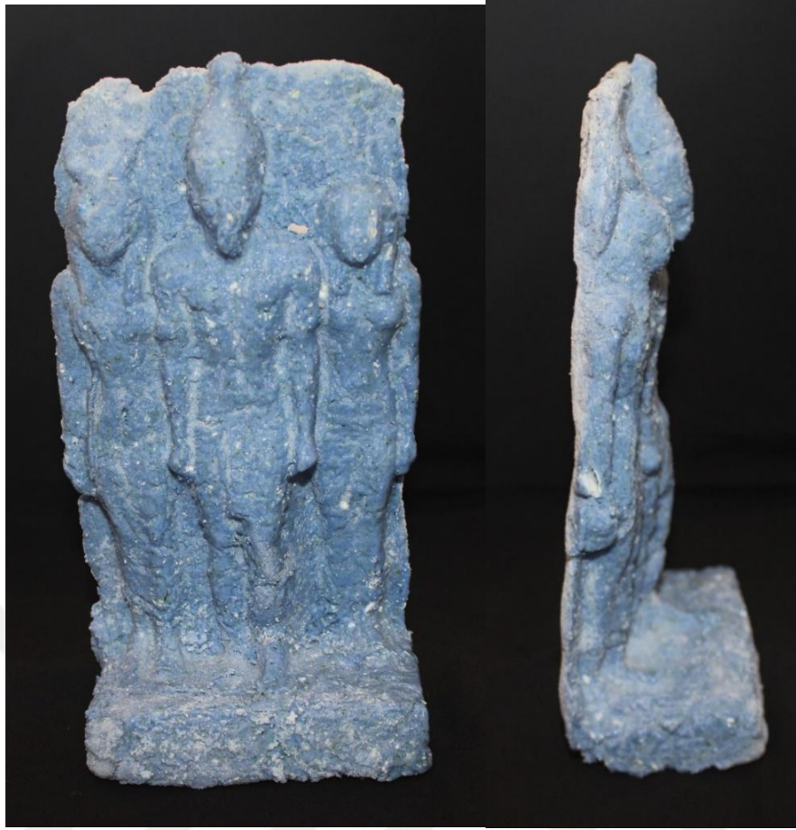
Görsel 46: İnorganik katı atıklardan mavi soda şişesi cam tozu katkılı Mısır pastası bünye (Reçete A11-3), Kral Mycerinus Üçlüsü Hathor ve Nome Figürini, 20x15x6 cm, 950 °C, (Özlem Sağlıyan Sönmez, 2024)
