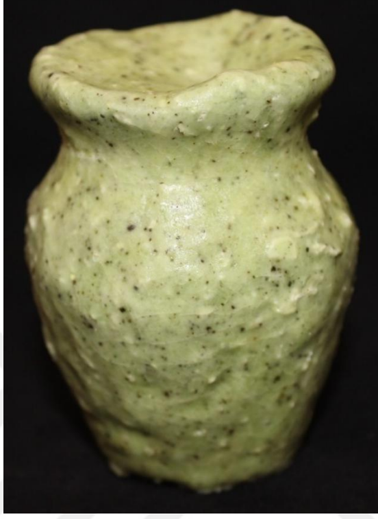
Görsel 60: İnorganik katı atıklardan yeşil soda şişesi cam tozu katkılı Mısır pastası bünye (Reçete A11-1), Şişe, 6x4 cm, 950 °C, (Özlem Sağlıyan Sönmez, 2024)
