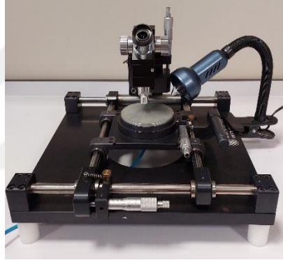
Şekil 3.53. Lazerlerin kesilmesi için kullanılan çizici (scriber) cihazı.
