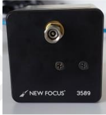
Şekil 3.48. Kullandığımız New Focus marka fotodedektör.
