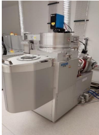
Şekil 3.15. Temiz odada aşındırma yaparken kullandığımız ICP-RIE cihazı.
