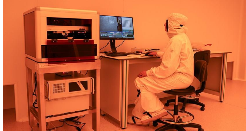
Şekil 3.6. Temiz odada maskesiz hizalama cihazında gerçekleştirdiğimiz litografi işlemi.
