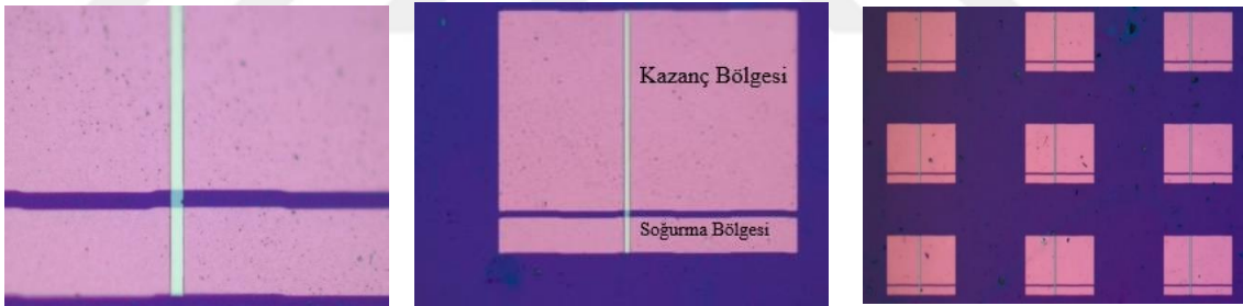
Şekil 3.39. Tek kazançlı lazerler için optik mikroskop görüntüleri.
