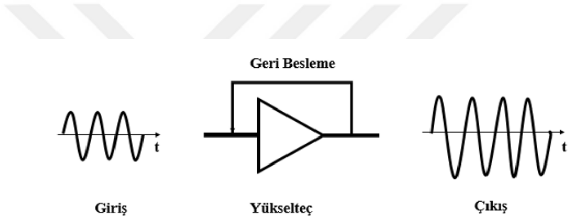
Şekil 1. 1. Yükselteç şematiği (Çakmak 2018).
